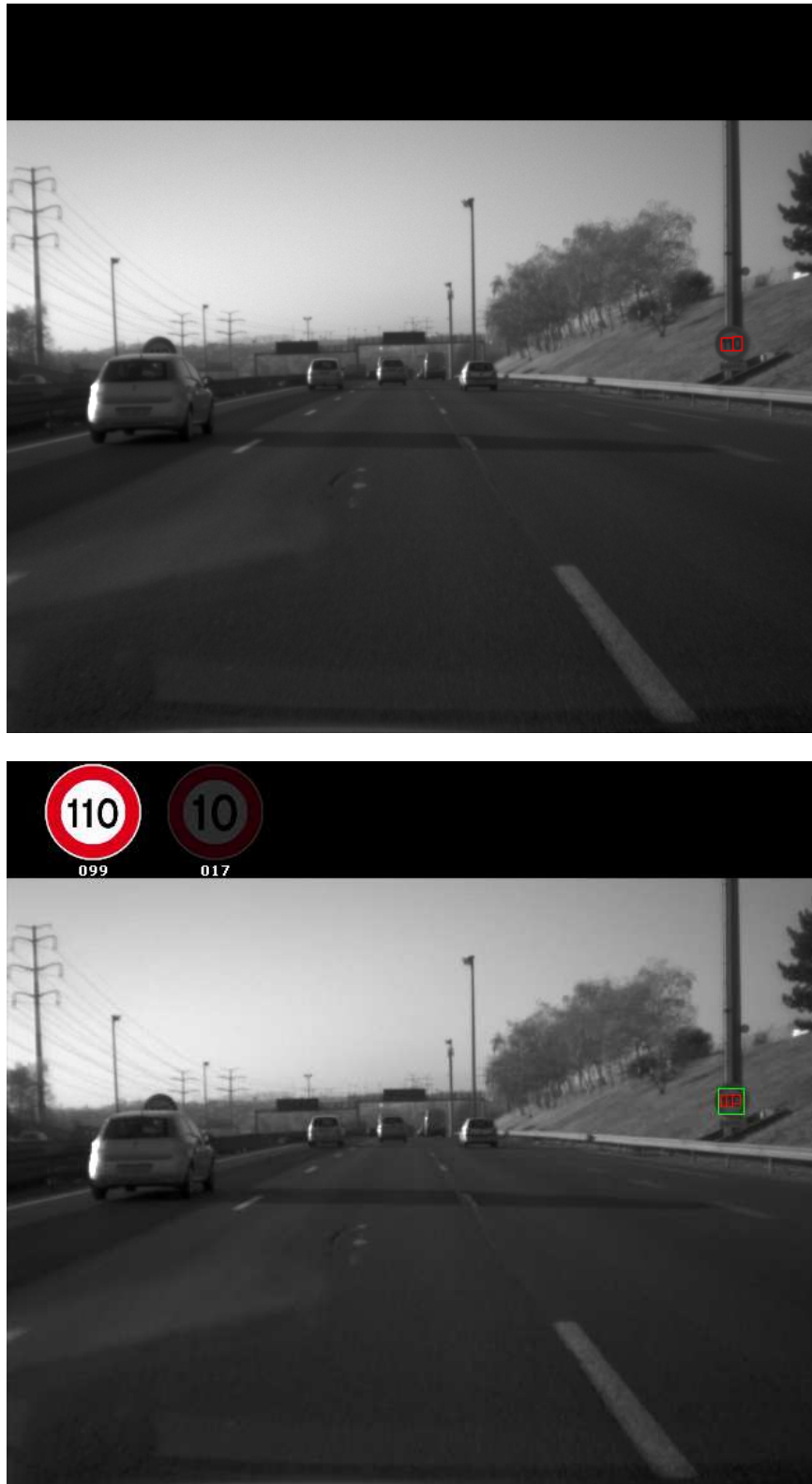
Figure 83 – Exemple de l'apport de l'algorithme de segmentation globale (en bas) face à l'algorithme initial (en haut) – Cas d'un panneau trop petit. A noter le panneau occulté sur la gauche.
