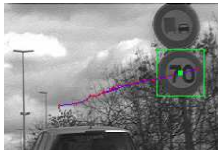
Figure 49 – Résultat du suivi temporel par moindres carrés d'un panneau
