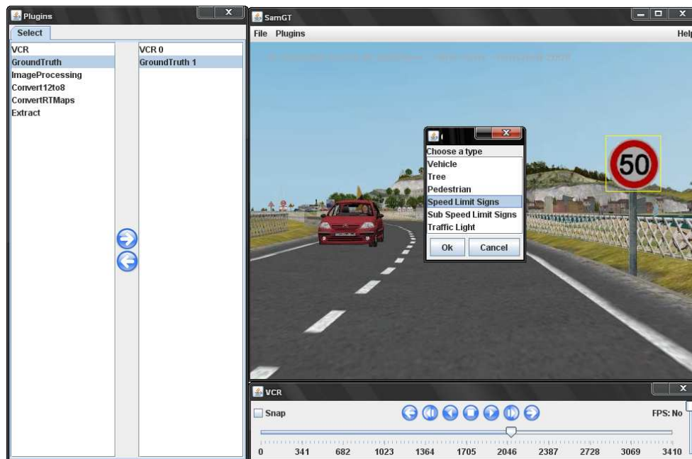
Figure 178 - Création d'une vérité terrain sous SamGT
