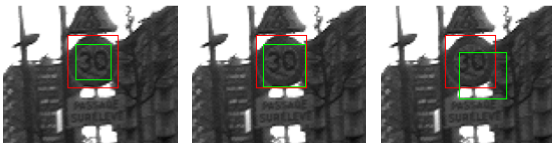
Figure 182 - Différentes détections possibles pour le panneau de limitation de vitesse par un algorithme (en vert) comparé à la vérité terrain (en rouge) bien que conservant un ratio de 1.
