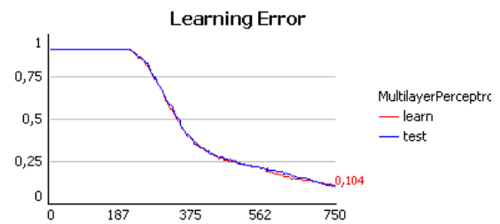
Figure 205 - Graphe d'apprentissage d'un Perceptron Multicouches à 11 neurones sur la couche cachée sur la base de chiffres
