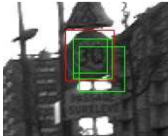
Figure 185 - Plusieurs détections possibles au même instant par un algorithme de détection (en vert), comparé à la vérité terrain (en rouge)
