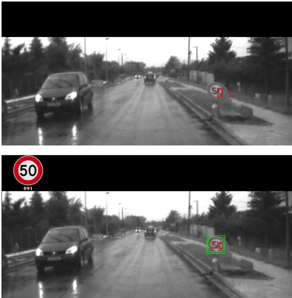
Figure 85 - Exemple de l'apport de l'algorithme de segmentation globale (en bas) face à l'algorithme initial (en haut) – Cas d'un panneau temporaire mal incliné
