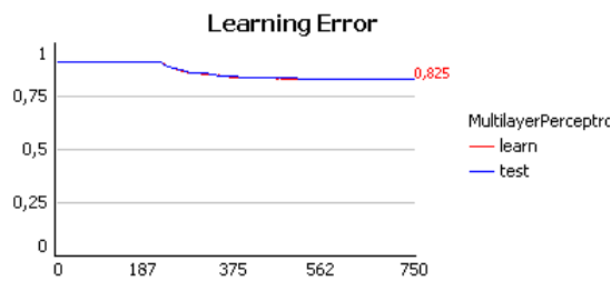
Figure 204 - Graphe d'apprentissage d'un Perceptron Multicouches à 1 neurone sur la couche cachée sur la base de chiffres
