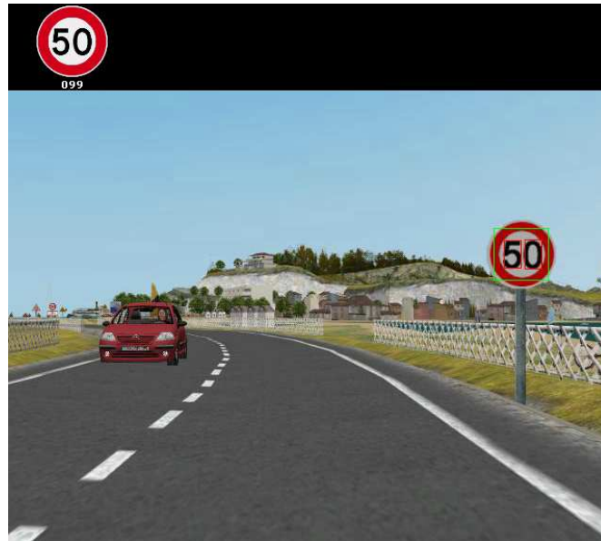
Figure 79 – Exemple de résultat de détection obtenu sous le simulateur Oktal
