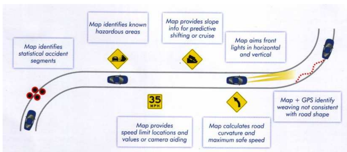
Figure 104 - Applications possibles aux systèmes ADAS d'un capteur cartographique (source NAVTEQ)
