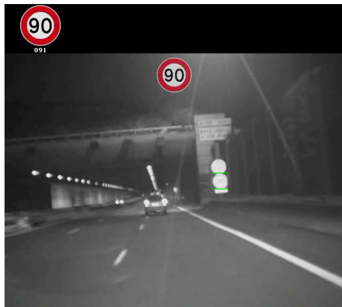
Figure 91 - Détection et reconnaissance d’un panneau de limitation de vitesse de nuit
