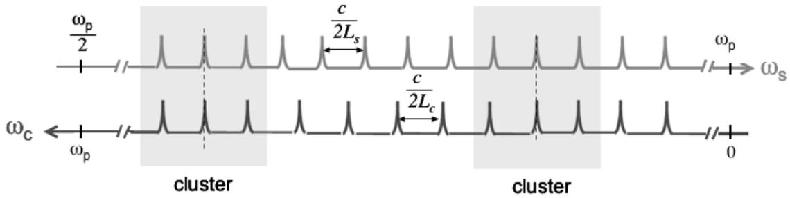
Fig.3. 12 : Diagramme de Giordmaine et Miller : mise en évidence de cluster de modes dans un OPO doublement résonant
