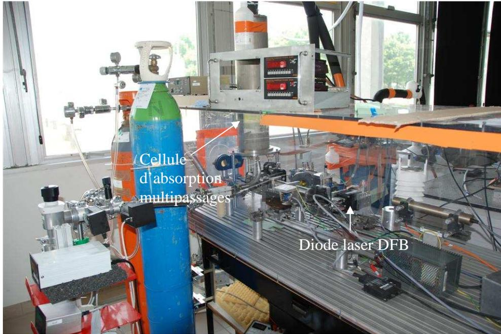
**Fig.2. 4 : Spectromètre à diode laser du GSMA**
