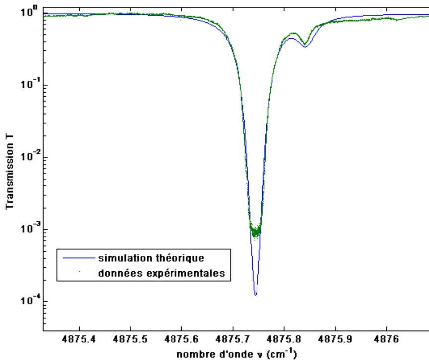
**Fig.3. 28 :** Transmissions, théorique simulée d'après les données de HITRAN 2004, et expérimentale étalonnée à l'aide d'un étalon Fabry-Perot, de la raie R30 après traversée de la cellule multi-passages avec  $p=160$  hPa et  $L=11.65$  m
