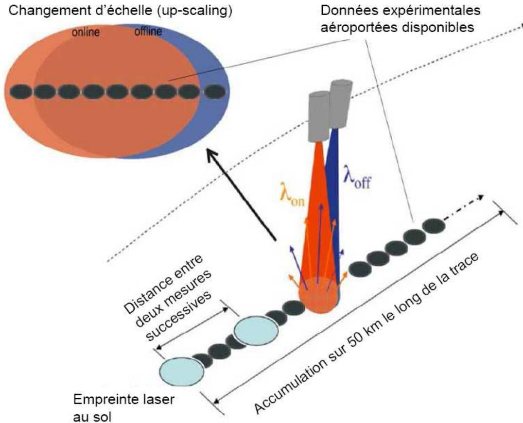
**Fig.4. 11 : Principe de mesure de la mission A-SCOPE et schéma du changement d'échelle effectué à partir des données aéroportées du DLR à 1.6  $\mu\text{m}$  [Amediak 2009]**
