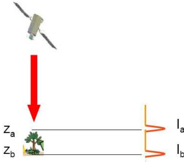
**Fig.4. 9 : Schéma de principe de tirs sur canopée à multiples réflexions**
