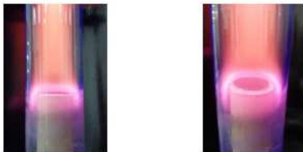
**Figure II.5 : Photographie de l'échantillon placé perpendiculairement au flux gazeux**
