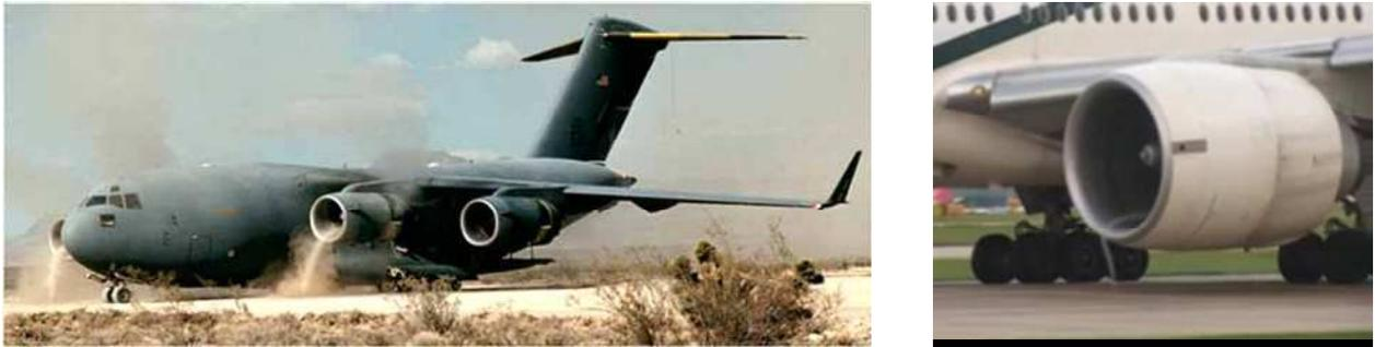
Figure Annexe IV.3. 1 : Photographie montrant l'aspiration de poussières dans les turbines d'avions au décollage
