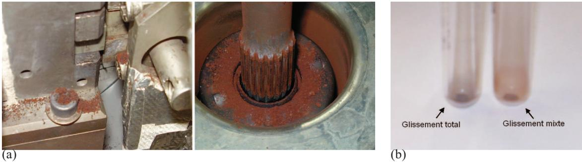
**Figure 5.19.** (a) Comparatif des débris d'usure entre la liaison cannelée (à droite) et le STS (à gauche). (b) Comparatif de coloration entre les débris récoltés en glissement mixte (à droite) et ceux récoltés en glissement total (à gauche).
