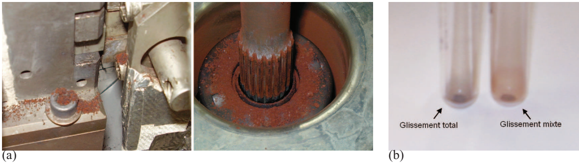
Figure 5.19. (a) Comparatif des débris d'usure entre la liaison cannelée (à droite) et le STS (à gauche). (b) Comparatif de coloration entre les débris récoltés en glissement mixte (à droite) et ceux récoltés en glissement total (à gauche).
