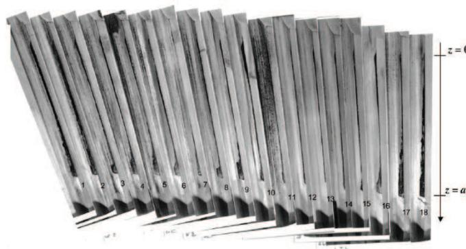
**Figure 1.9.** Observation microscopique des 18 flancs usés issus de l'arbre après essai. La répartition d'usure n'est pas uniforme (d'après [90]).
