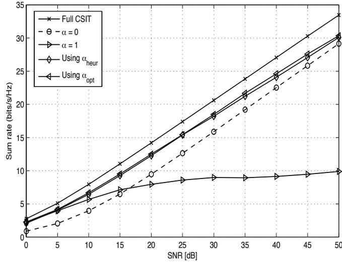
Figure 2: Débits moyens pour  $N_t = 2$ ,  $K = 30$ ,  $B_{total} = 120$  bits, et différentes valeurs de  $\alpha$ . Les débits obtenus en utilisant  $\alpha_{heur}$  qui maximise  $f_{PL}$  sont presque aussi élevés que ceux obtenus en utilisant  $\alpha_{opt}$ .
