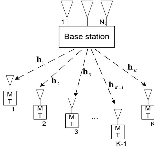
Figure 1 : Canal MIMO Broadcast : une station de base équipée de  $N_t$  antennes communique avec  $K$  récepteurs à une antenne chacun.  $\mathbf{h}_k \in \mathbb{C}^{1 \times N_t}$  est le vecteur des coefficients du canal en voie descendante de l'utilisateur  $k$ ,  $k = 1, \dots, K$ .
