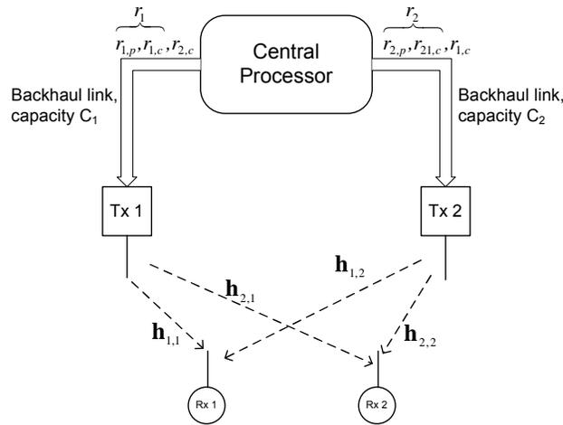
Figure 12: Coopération sous un backhaul de capacité limitée.
