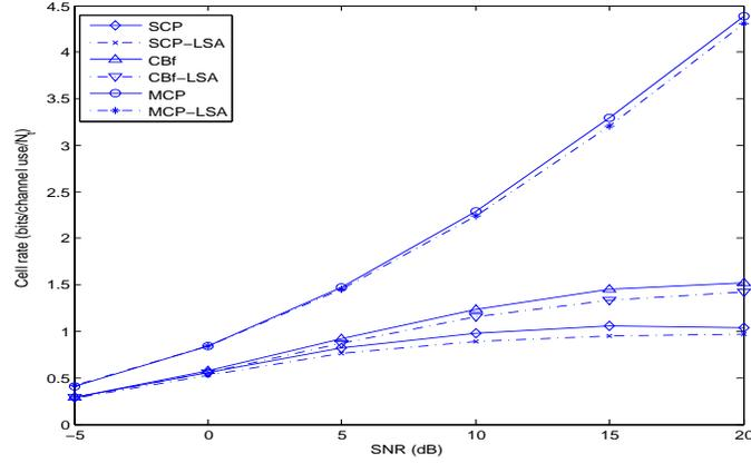
Figure 16: Comparaison pour  $\epsilon = 0.5$ , entre les débits moyens normalisés par cellule réalisés en appliquant les beamformers asymptotiquement optimaux pour un système de dimensions finies ( $K = 3, N_t = 4$ ) et ceux résultant de l'analyse grands systèmes avec  $\beta = 0.75$ .
