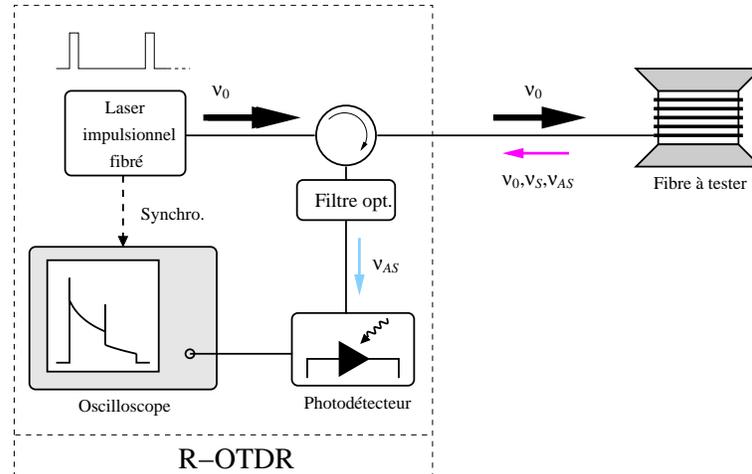
FIGURE I.36: Schéma de principe d'un R-OTDR.
