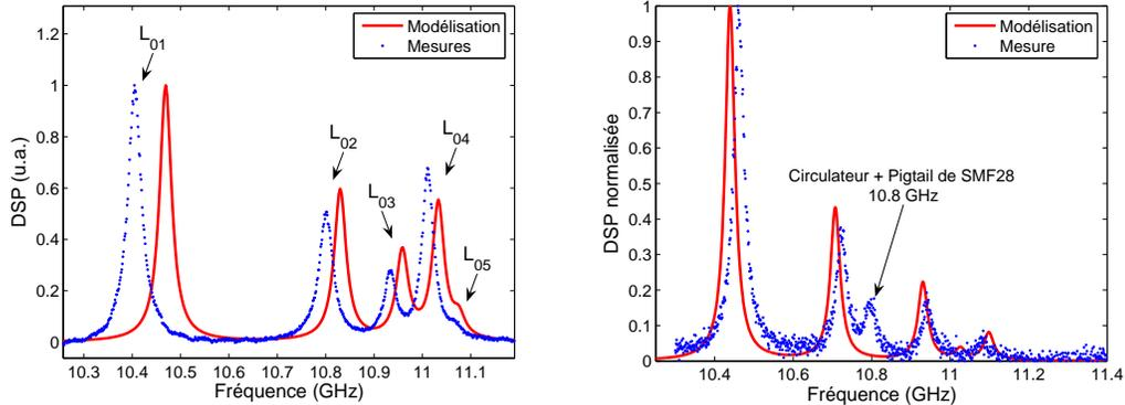
FIGURE II.15: Comparaison des spectres mesurés et simulés de fibre de type LEAF de 20 km (puissance de pompe très faible  $P_0 \approx -10$  dBm) et DSF de 10 m (puissance injectée très forte  $P_0 \approx 25$  dBm)
