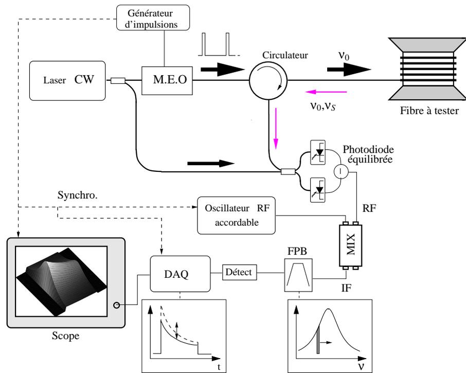
FIGURE III.2: Système B-OTDR utilisant une analyse spectrale électrique
