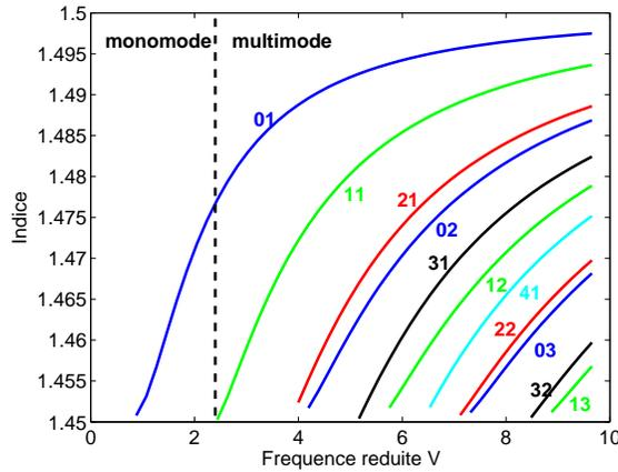
FIGURE I.16: Classification des différents modes optiques par leurs indices effectifs en fonction de la fréquence réduite. L'indice de cœur de cette fibre est  $n_c = 1,5$  et l'indice son gaine est  $n_g = 1,45$ .
