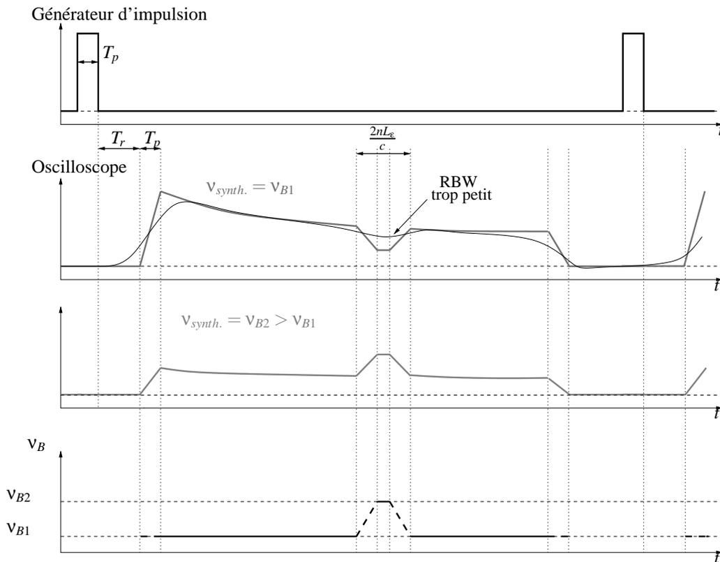
FIGURE III.7: Chronogramme du signal émis par le générateur d'impulsion (haut), des signaux reçus par l'oscilloscope pour 2 fréquences du synthétiseur  $\nu_{B1}$  et  $\nu_{B2}$  (centre), mesure répartie de fréquence Brillouin (bas). L'effet d'un filtre de résolution trop étroit est également présenté sur le deuxième chronogramme.
