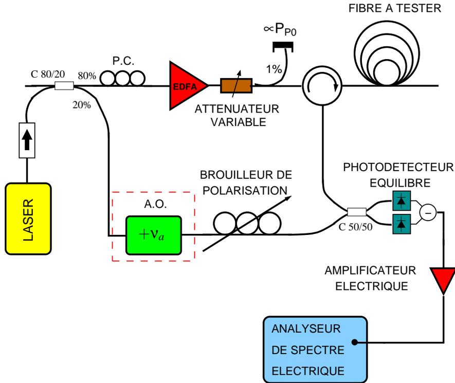
FIGURE II.12: Expérience de mesure du spectre Brillouin Spontané
