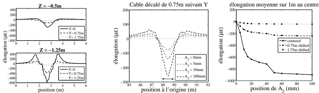
FIGURE IV.10: (Gauche) Mesure de déformations à différentes positions relativement au trou. (Centre et droite) Effet de l'augmentation de la profondeur de la cavité sur le profil des déformations.
