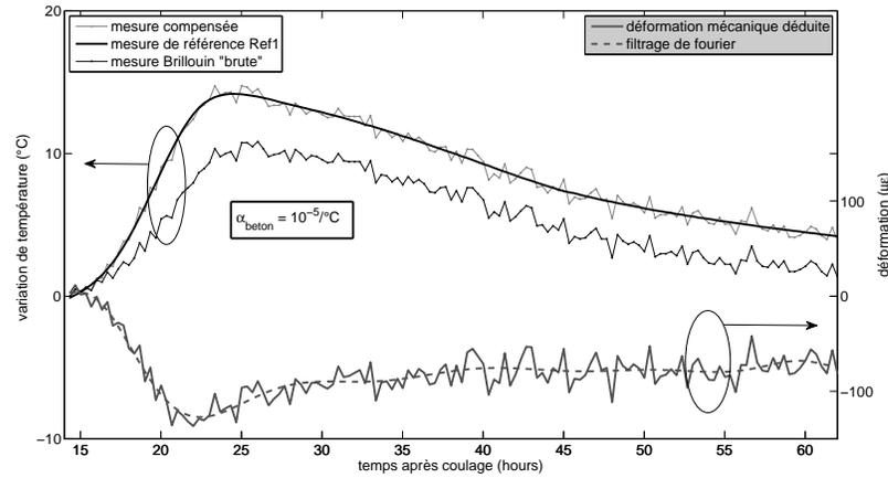
FIGURE IV.20: Mesure de température du capteur S<sub>1</sub> et sa référence associée. Interprétation suivant 2 hypothèses : prise en compte seulement des déformations thermiques du béton via (courbe grise), interprétation de la différence de mesure entre S<sub>1</sub> et la mesure référence comme présence de déformations mécaniques liées au retrait du béton au jeune âge.
