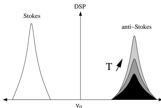
FIGURE I.34: Evolution du spectre Raman avec la température.
