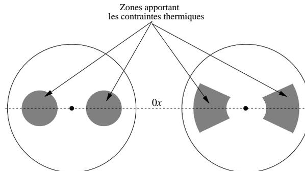
FIGURE I.19: Section de deux fibres à maintien de polarisation. À gauche une fibre de type PANDA, et à droite une fibre de type Bow-Tie.
