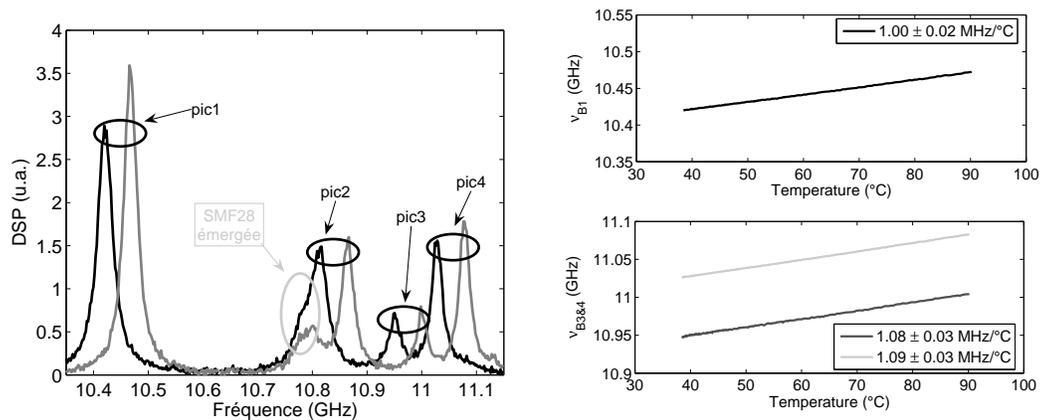
FIGURE III.14: (Gauche) Spectres obtenus à  $T = 40\text{ }^{\circ}\text{C}$  (noir) et  $T = 85\text{ }^{\circ}\text{C}$ . (Droite) Décalages Brillouin mesurés pour les premier, troisième et quatrième pics.
