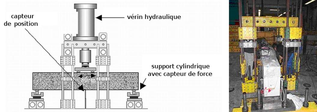
FIGURE IV.22: Dispositif de mise en flexion de la poutre : à gauche un schéma, à droite une photographie.
