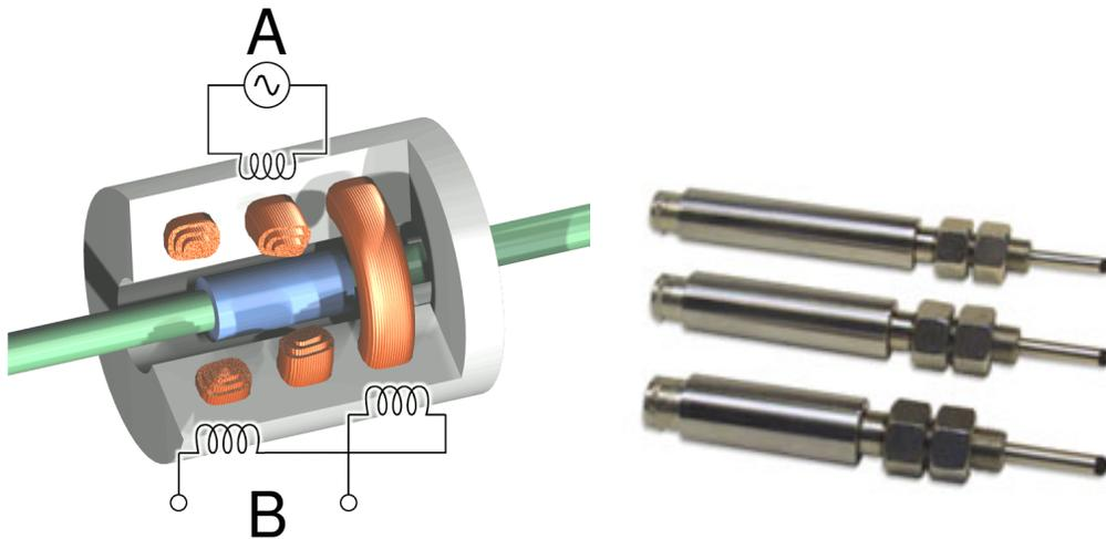
FIGURE I.8: Principe de fonctionnement d'une LVDT (gauche). *A* est le transformateur primaire, *B* est le transformateur secondaire. L'élément cylindrique central est le noyau. Un capteur commercial (droite).
