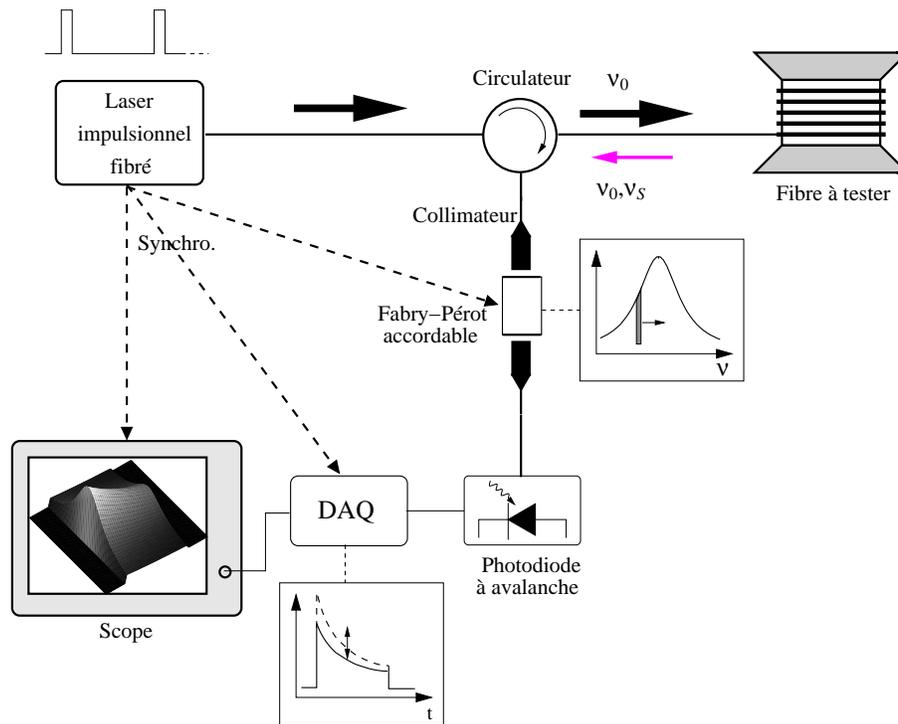
FIGURE III.1: Système B-OTDR utilisant une analyse spectrale optique
