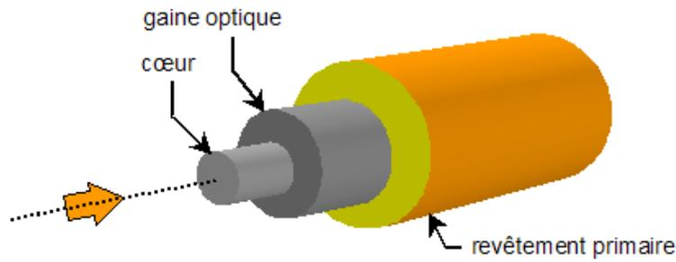
FIGURE I.12: Principaux éléments d'une fibre à saut d'indice
