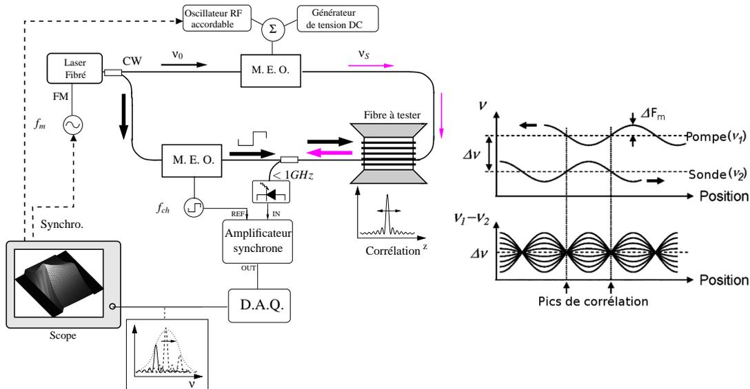
FIGURE III.5: Système B-OCDA, et son principe de base.
