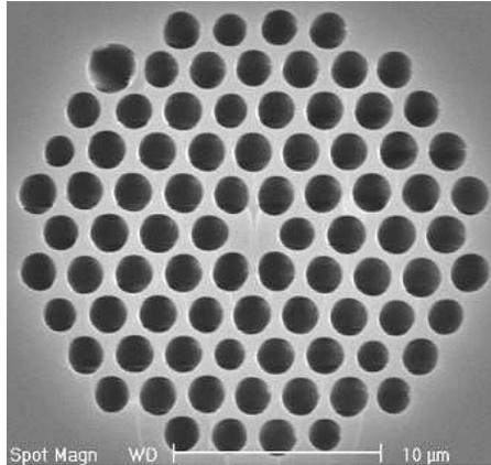
FIGURE II.16: Photo (prise au microscope électronique à balayage) d'une fibre microstructurée de type 1204, fabriquée par Xlim, la taille des trous est  $d = 1,8 \mu\text{m}$ , et le pas de la maille  $\Lambda = 2,25 \mu\text{m}$ .
