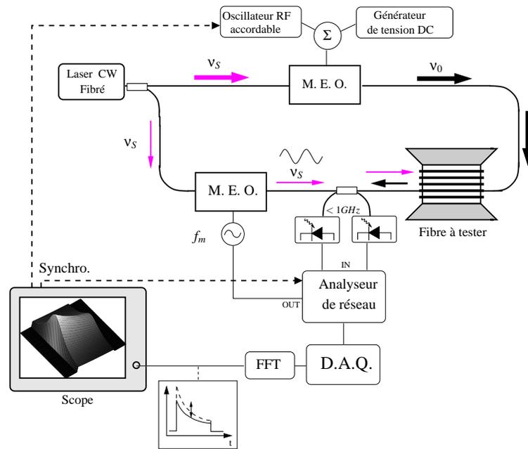
FIGURE III.4: Système B-OFDA utilisant une analyse des pertes.
