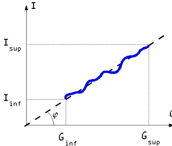
FIGURE I.3: Courbe de sensibilité d'un dispositif de mesure.  $\phi$  est le coefficient de sensibilité,  $G_{sup} - G_{inf}$  constitue l'étendue de mesure. La linéarité peut être qualifiée en mesurant l'écart entre la courbe de mesure et la droite au sens des moindres carrés. La détermination de la courbe de sensibilité est souvent appelée **étalonnage**.
