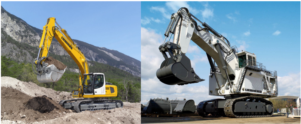
Figure 75 - Pelles hydrauliques sur chenilles LIEBHERR, de 25 tonnes (gauche) et 800 tonnes (droite)
