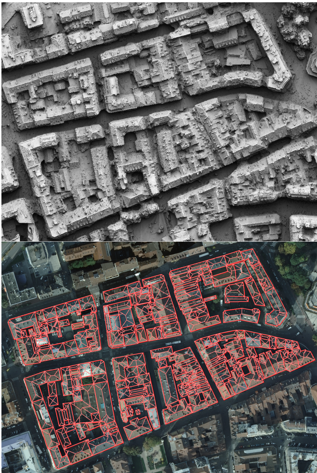
FIGURE 17 – Zone test sur Amiens, France : (haut) MNS et (bas) modèles 3D de bâtiments filaires sur un fond orthophotographique.
