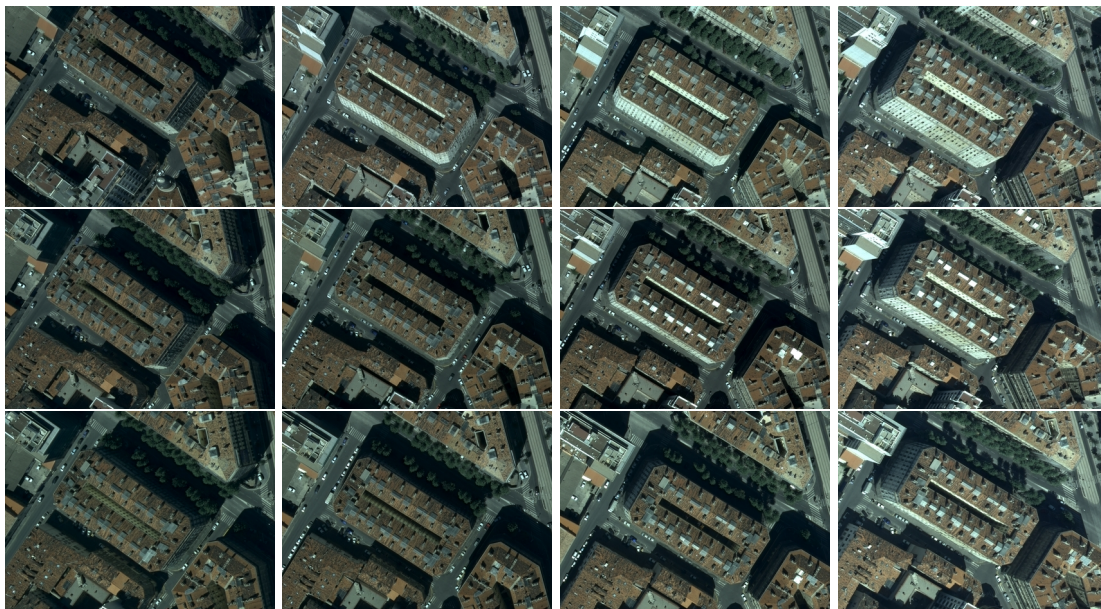
FIGURE 3 – Imagerie aérienne multivue : Bâtiment vu depuis 12 points de vue aériens différents (Ces imageries 1186x880 sont extraites d'images aériennes 13824x7680 pixels).
