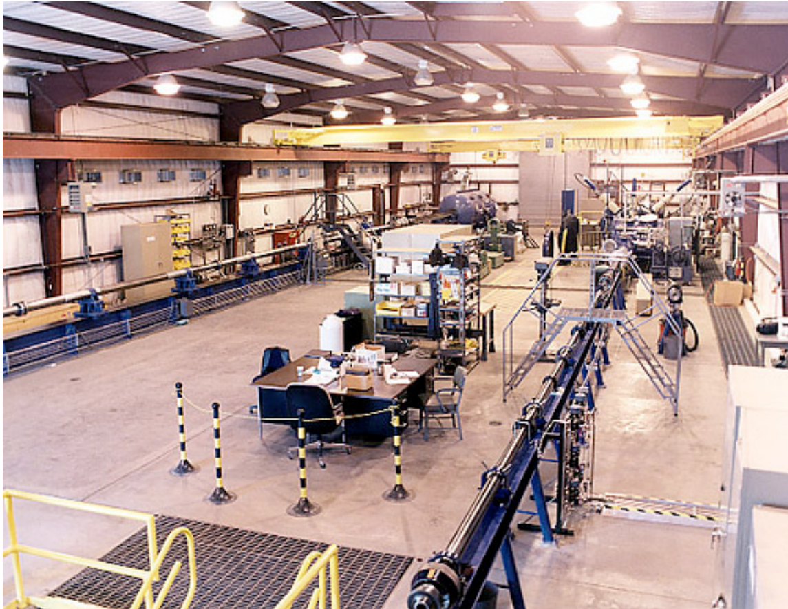
Figure 1.3 : Exemple de canon à gaz à deux étages d'accélération (NASA Hypervelocity Impact Test Facility)
