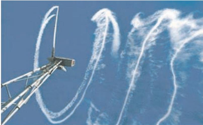
FIGURE 1.2 – Expérience réalisée par le Centre danois de recherche sur l'énergie "Risø", montrant le sillage d'une éolienne à une seule pale [63].
