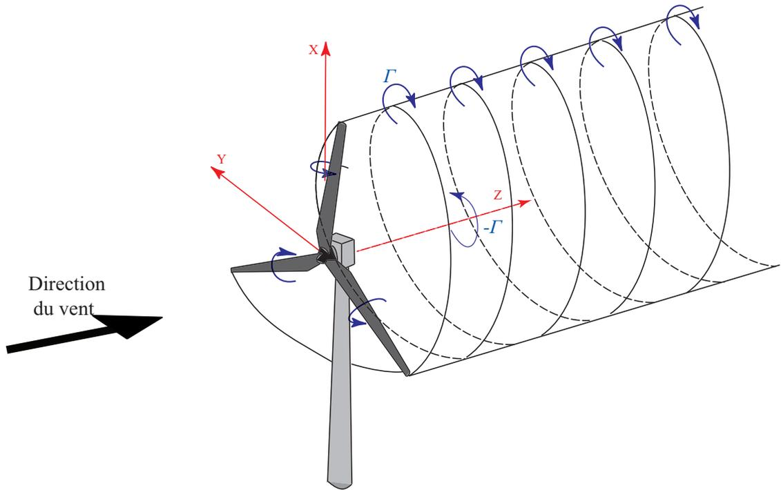
FIGURE 1.9 – Sillage prescrit de forme cylindrique d'une éolienne
