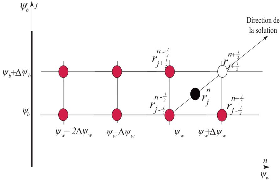
FIGURE 2.9 – Discrétisation par l'utilisation d'un schéma explicite de 5 points
