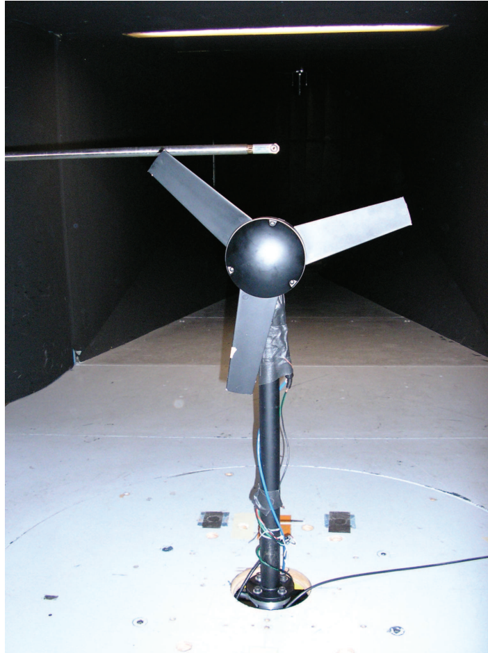
FIGURE 4.1 – Rotor éolien Rutland 503 testé dans la veine d'essai de la soufflerie d'Arts et Métiers ParisTech
