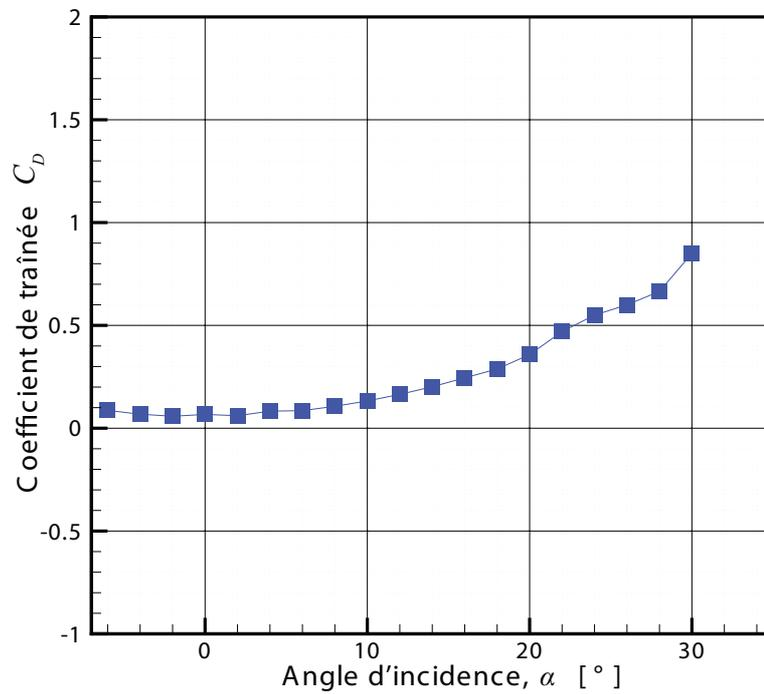
FIGURE 4.7 – Coefficients de traînée pour l'éolienne Rutland 503.
