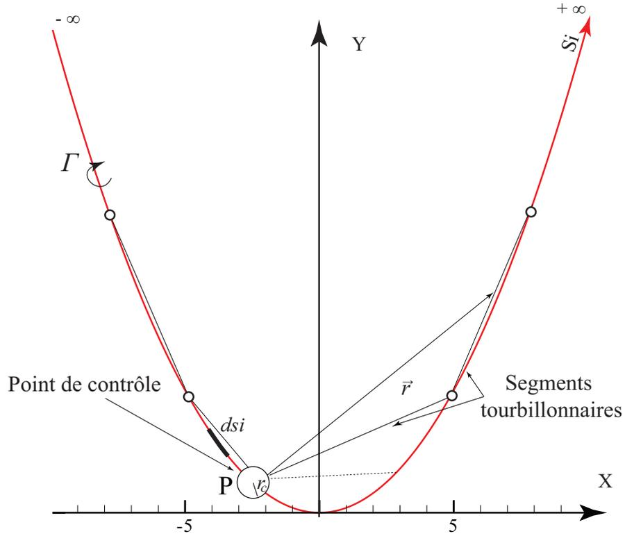
FIGURE 3.14 – Tourbillon parabolique divisé en plusieurs segments
