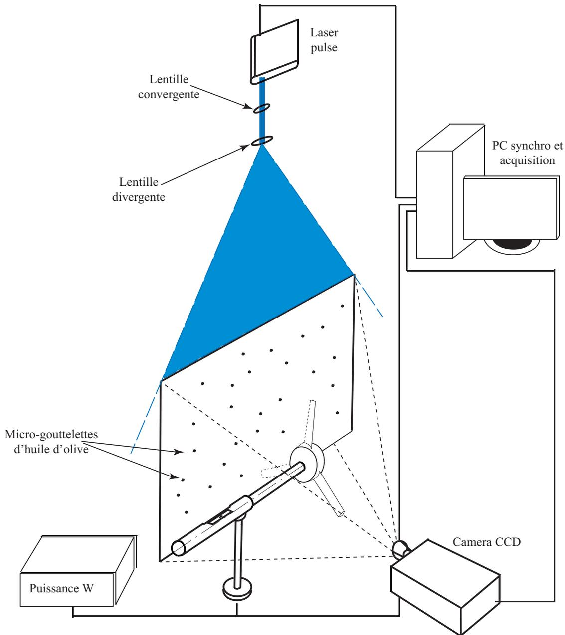
FIGURE 4.5 – Schéma de l'installation pour les mesures par *PIV*
