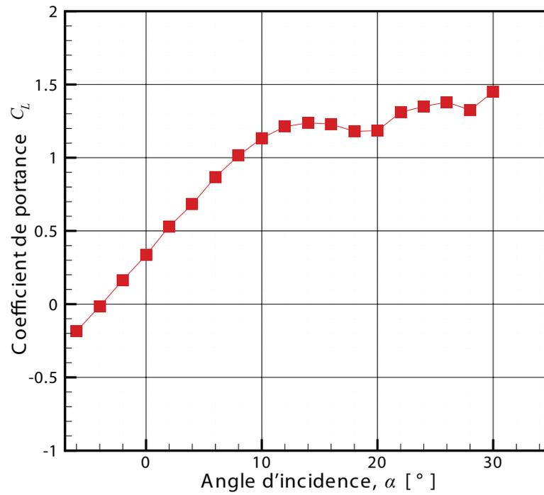
FIGURE 4.6 – Coefficients de portance pour l'éolienne Rutland 503.
