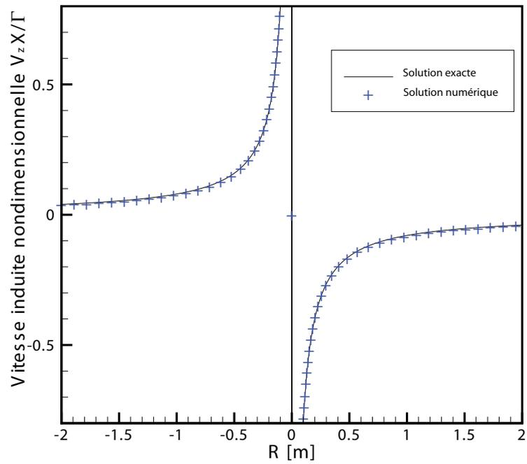
FIGURE 3.2 – Vitesse induite par un filament tourbillonnaire rectiligne infini
