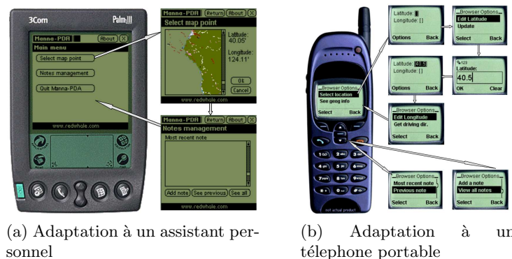
Figure II.11 – Adaptations et exemples de dialogues pour un même système par la sélection de modèles de plate-forme, de tâche et de présentation appropriés ( )
