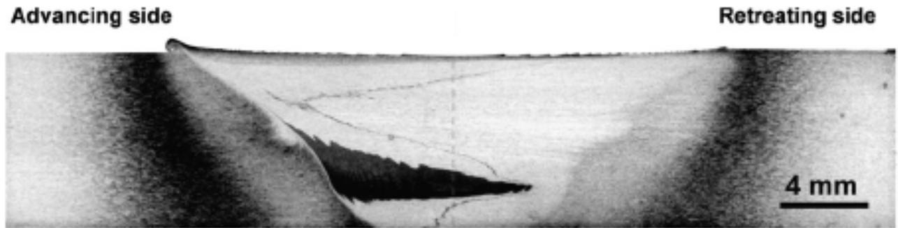
FIGURE 1.6 – Coupe transversale d'un joint avec feuillard longitudinal,  $V = 76\text{mm/min}$  et  $\omega = 240\text{tr/min}$  [XD08]
