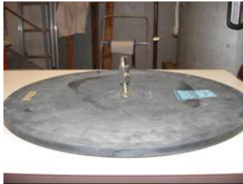
Figure 2. 14 – Baudruche formée de membranes Pronal, utilisée pour le chargement à pression contrôlée
