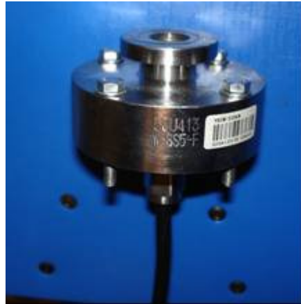
Figure 2. 9 – Capteur d'effort de 5 kN (instrumentation de la tête de l'inclusion)
