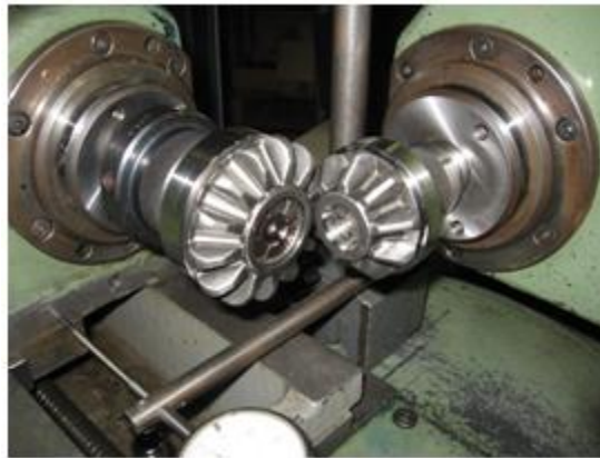
Figure 2-36 – Engrenage contrôlés sur banc d'engrénométrie [Berviller 2006].
