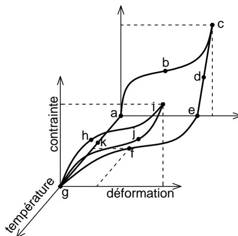
Figure 2.6. Comportement quasi statique uniaxial thermomécanique des SMA [16]
