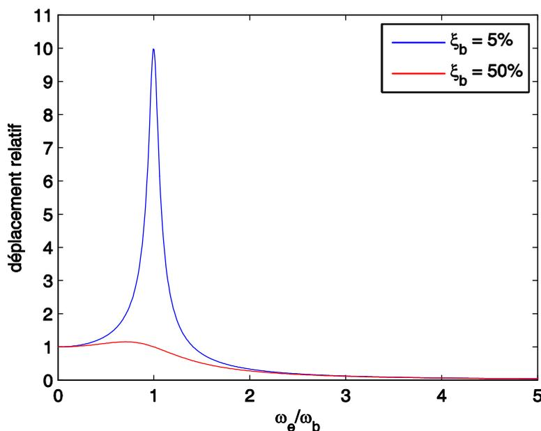
**Figure 4.3. Module de la fonction de transfert du déplacement relatif normalisé**
