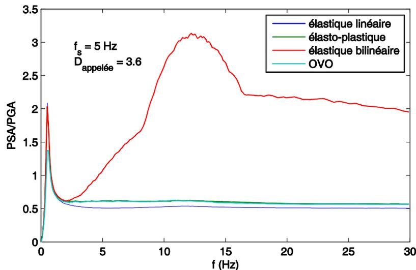
**Figure 3.14. Spectres médians en pseudo-accelération normalisée à la base de la superstructure ( $f_s = 5$  Hz,  $D_{appelée} = 3.6$ )**
