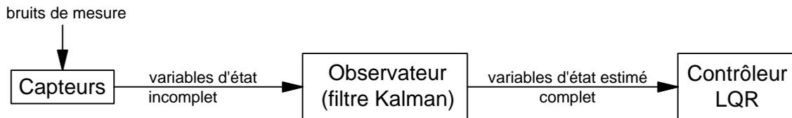
Figure 5.1. Principe de la méthode LQG
