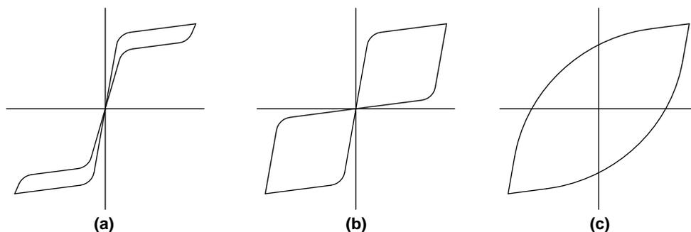
**Figure 2.8. Comportements typiques des dispositifs d'isolation de SMA [17] :**
