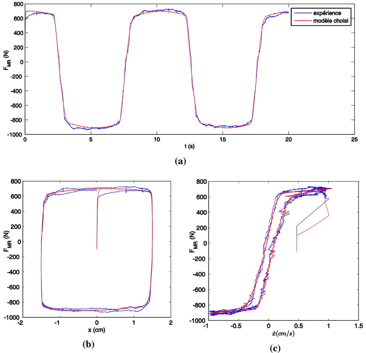
Figure 6.13. Modèle choisi sous une excitation sinusoïdale  $0.1 \text{ Hz}$ , amplitude  $\pm 1.5 \text{ cm}$ , avec un courant  $0.5 \text{ A}$  : a) force-temps ; b) force- déplacement ; c) force-vitesse
