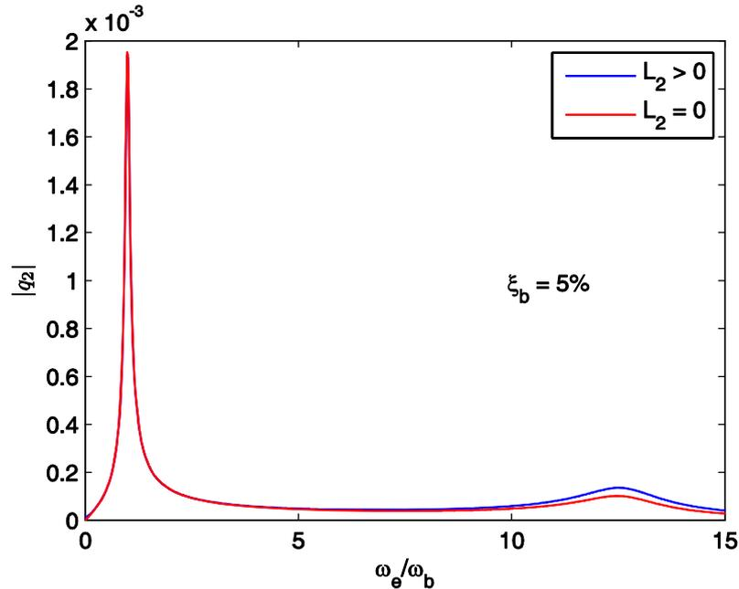
**Figure 4.7. Module de la fonction de transfert de la réponse du deuxième mode**
