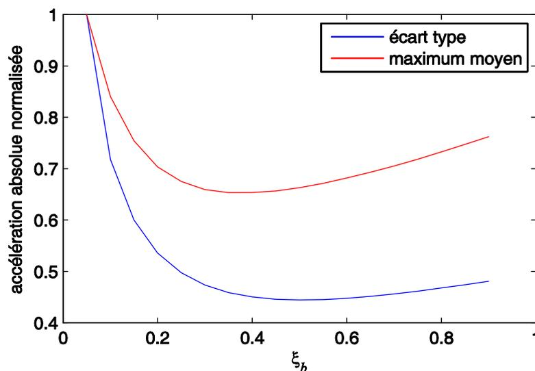
**Figure 4.4. Évolutions de l'écart type et du maximum moyen de l'accélération absolue (normés par rapport aux valeurs à amortissement 5%) en fonction de l'amortissement dans le cas d'une excitation bruit blanc**
