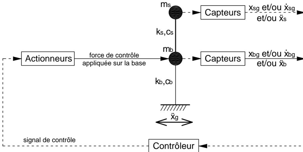
Figure 5.2. Modèle à deux DDL en boucle fermée
