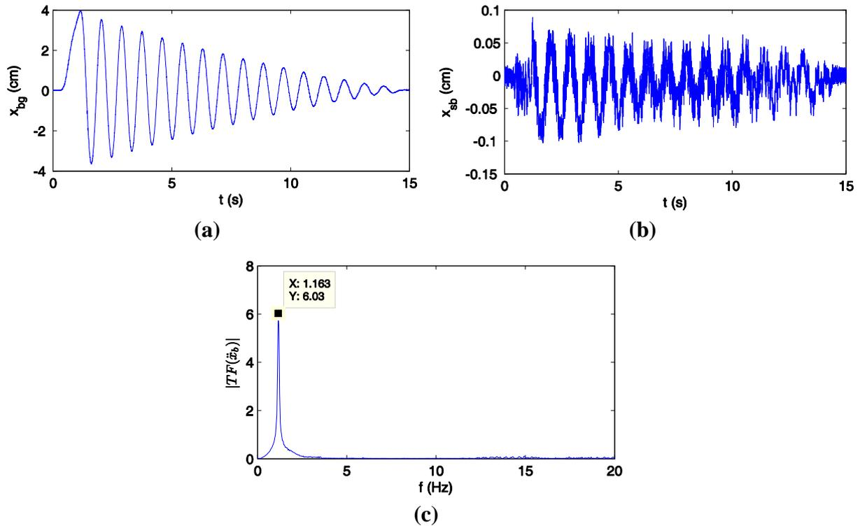
**Figure 7.3. Essai de lâcher : a) déplacement relatif de la base par rapport au sol ; b) déplacement relatif de la superstructure par rapport à la base ; c) module de la transformée de Fourier (TF) de l'accélération absolue de la base**
