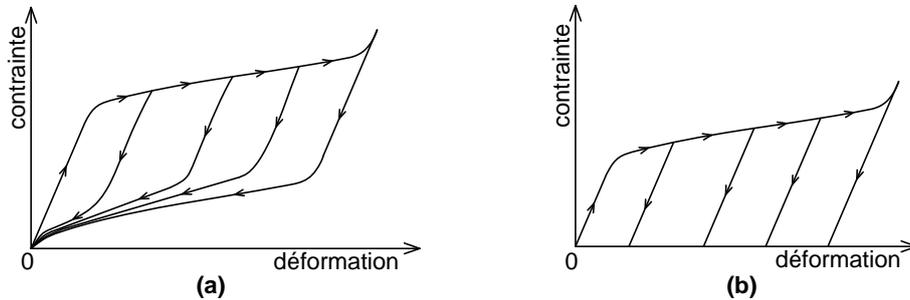
**Figure 2.7. Comportement en tension uniaxiale des SMA :**
