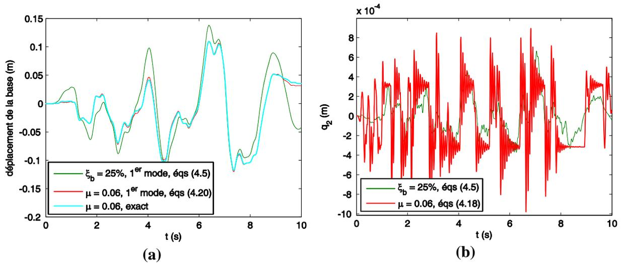
**Figure 4.17. Évolution temporelle des déplacements pour les cas d'amortissement visqueux et de frottement : a) déplacement de la base (frottement) et déplacement du premier mode (amortissement visqueux et frottement) ; b) déplacement du deuxième mode (amortissement visqueux et frottement)**
