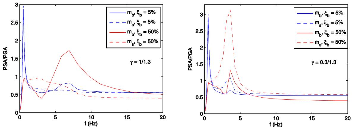
**Figure 4.12. Spectres de plancher en pseudo-accelération pour amortissement de 2% (normés par rapport à l'accélération maximale de l'excitation) pour deux valeurs du rapport de masse dans le cas d'une excitation bruit blanc filtré**
