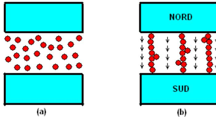
**Figure 6.1. Formation des chaînes de particules ferromagnétiques dans un fluide MR :**
