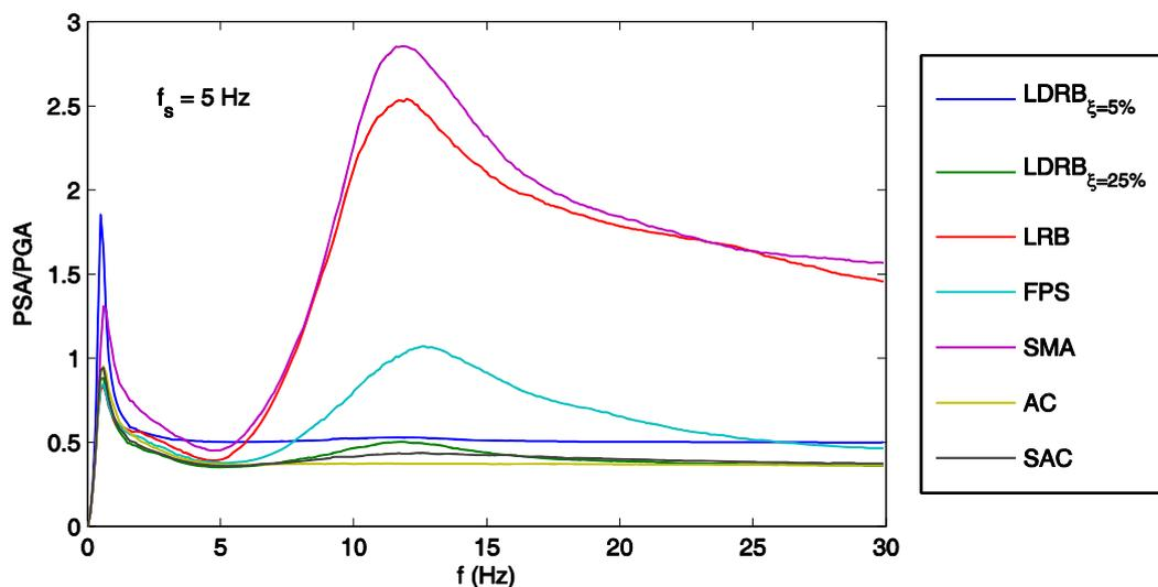
**Figure 3.11. Spectres médians en pseudo-accélération (PSA) normalisée de la base d'une superstructure élastique linéaire ( $f_s = 5\text{ Hz}$ )**
