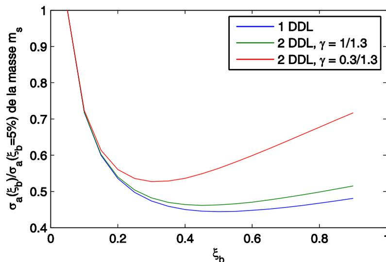
Figure 4.11. Évolution de l'écart type de l'accélération absolue (normés par rapport aux valeurs à amortissement 5%) en fonction de l'amortissement dans le cas d'une excitation de bruit blanc ( $\varepsilon = 1/36$ ,  $\xi_s = 3\%$ ). Comparaison entre systèmes à 1 DDL et 2 DDL.
