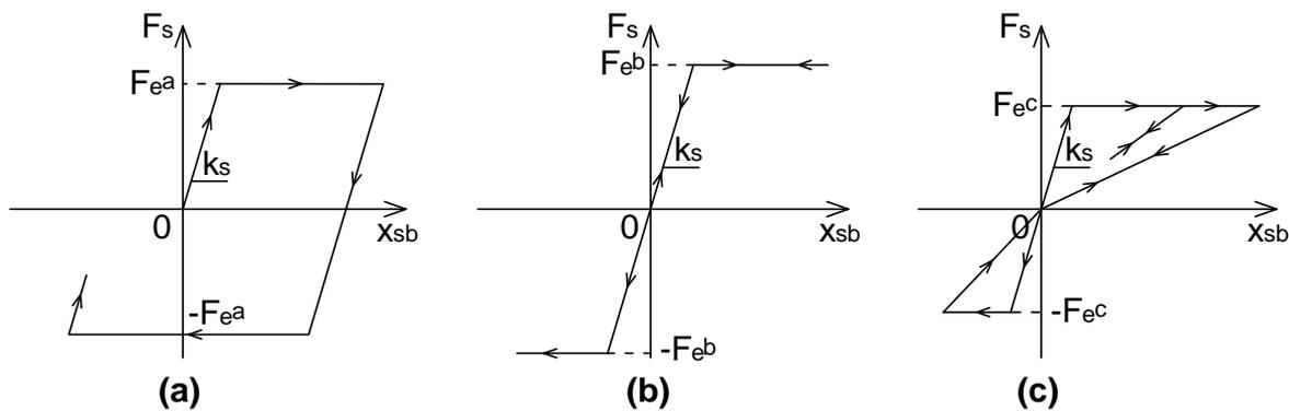
**Figure 3.5. Comportements non-linéaires de la structure conventionnelle et de la superstructure :**
