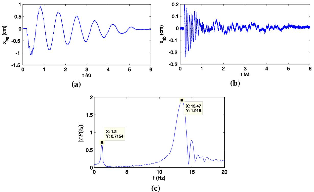
**Figure 7.4. Essai de choc à base libre : a) déplacement relatif de la base par rapport au sol ; b) déplacement relatif de la superstructure par rapport à la base ; c) module de la transformée de Fourier (TF) de l'accélération absolue de la base**
