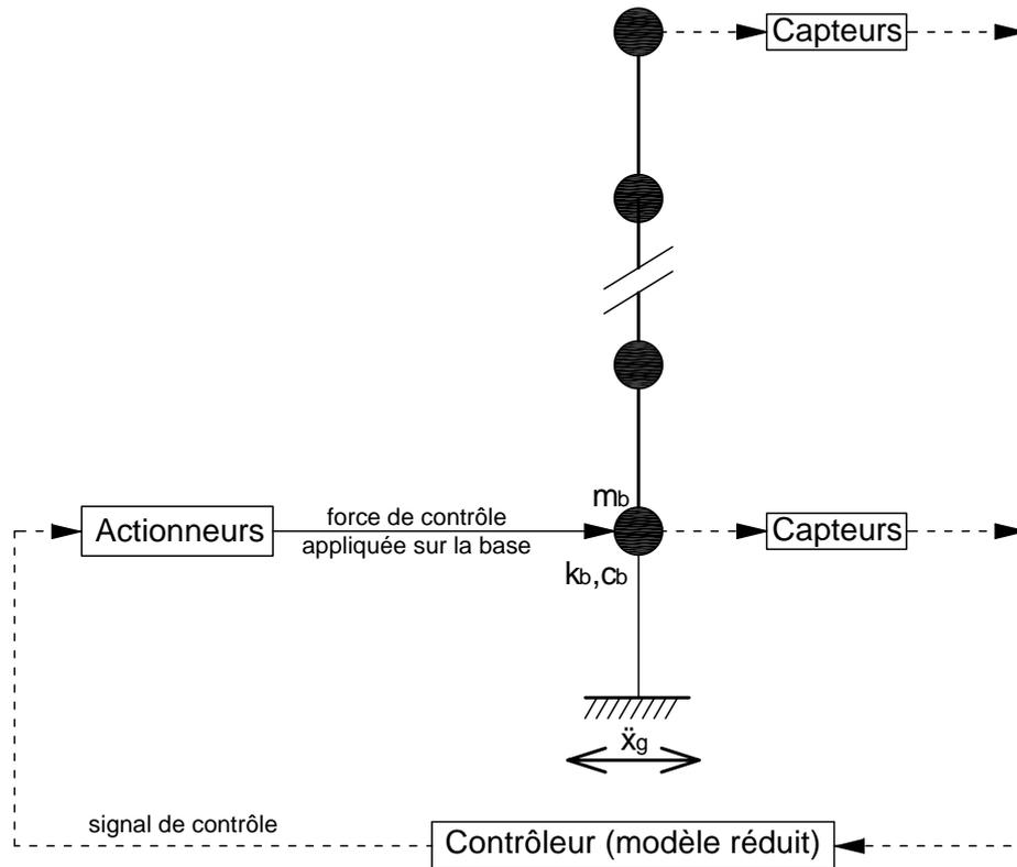
**Figure 5.9. Modèle à plusieurs DDL en boucle fermée**
