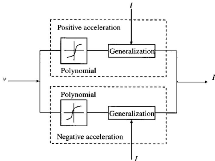
**Figure 6.9. Modèle polynomial pour l'amortisseur MR [74]**
