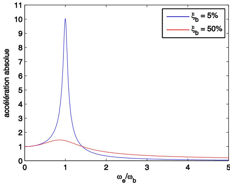
**Figure 4.2. Module de la fonction de transfert de l'accélération absolue**
