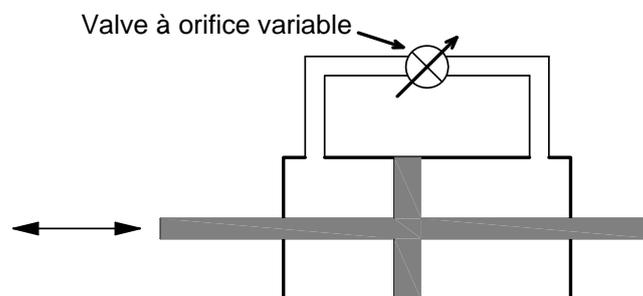
Figure 2.11. Schéma d'un amortisseur à orifice variable
