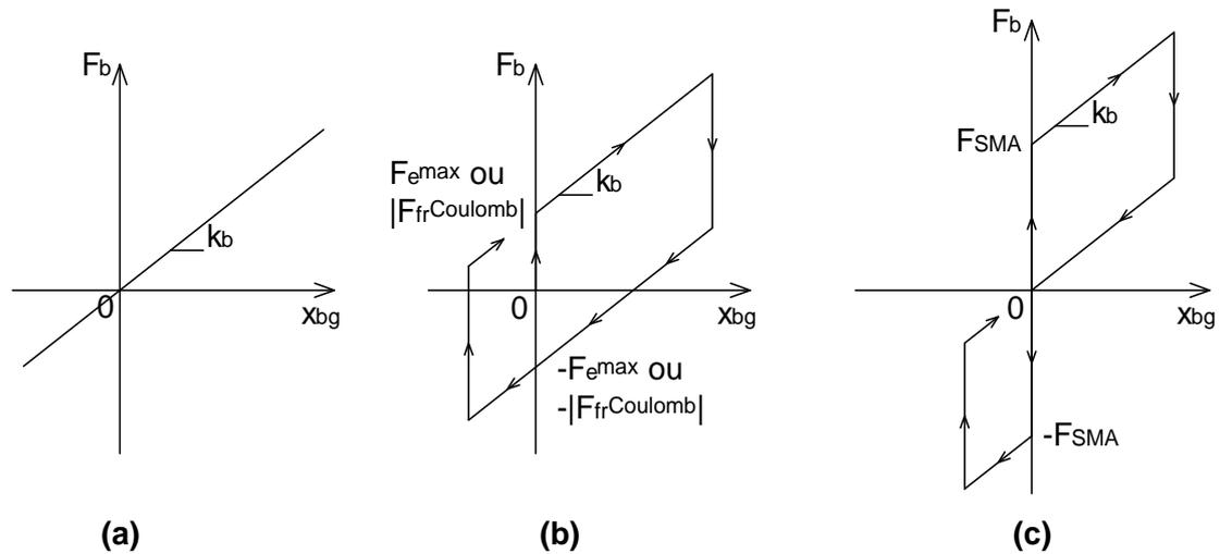
**Figure 3.2. Comportements des appuis passifs utilisés dans le modèle :**
