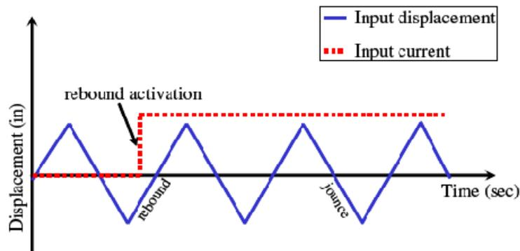
**Figure 6.14. Illustration des essais à vitesse constante avec un saut de courant électrique dans [77]**
