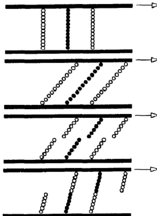
**Figure 6.2. Comportement des chaînes de particules d'un fluide MR soumis à une déformation de cisaillement [65]**
