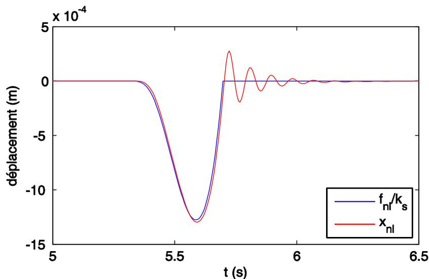
**Figure 3.17.** Évolution temporelle des forces non-linéaires et de la déformation due aux forces non-linéaires, pour une superstructure élastique bilinéaire ( $f_s = 5 \text{ Hz}$ ,  $D_{appelée} = 3.6$ )
