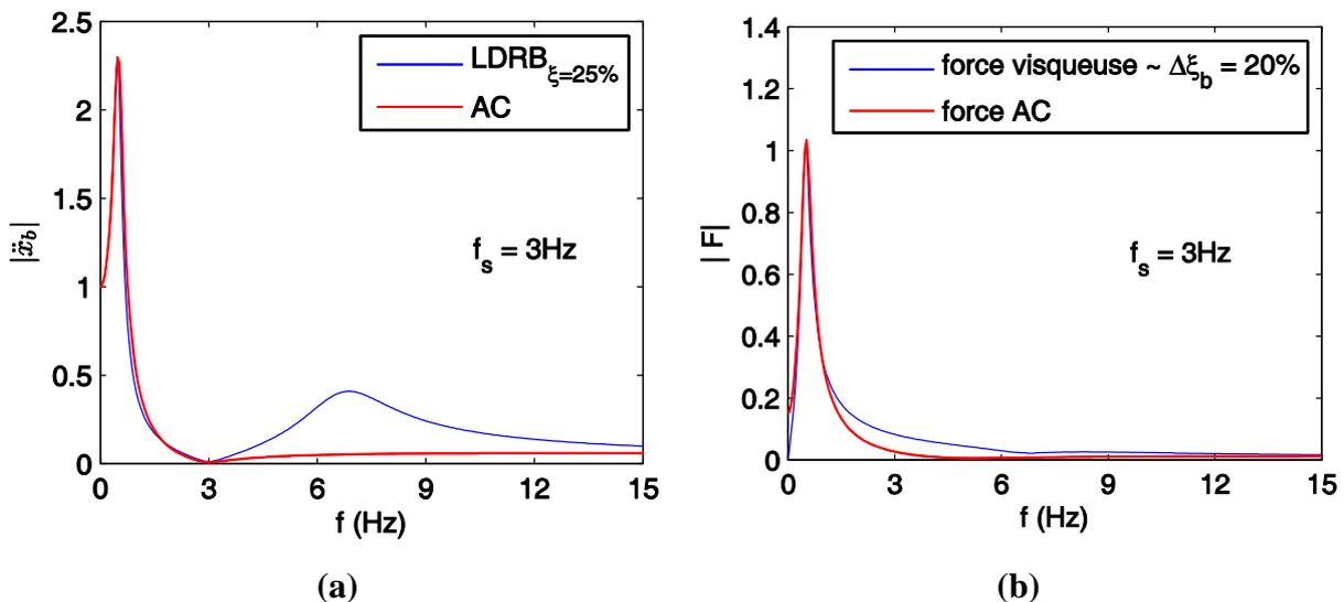
**Figure 3.4. Amplitude des fonctions de transfert des structures sur  $LDRB_{\xi=25\%}$  et sur AC :**
