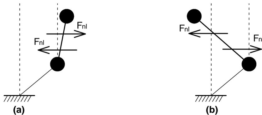
**Figure 3.15. Déformations modales de la structure isolée : a) du premier mode propre ; b) du deuxième mode propre**
