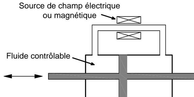
**Figure 2.12. Schéma d'un amortisseur à fluide contrôlable**
