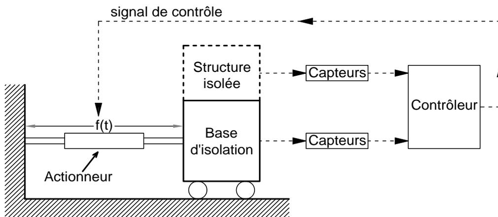
**Figure 2.10. Principe des systèmes de contrôle actif (AC – « Active Control »)**
