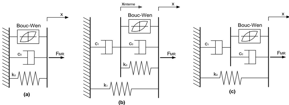
**Figure 6.12. Modèles d'amortisseur MR basés sur Bouc-Wen :**
