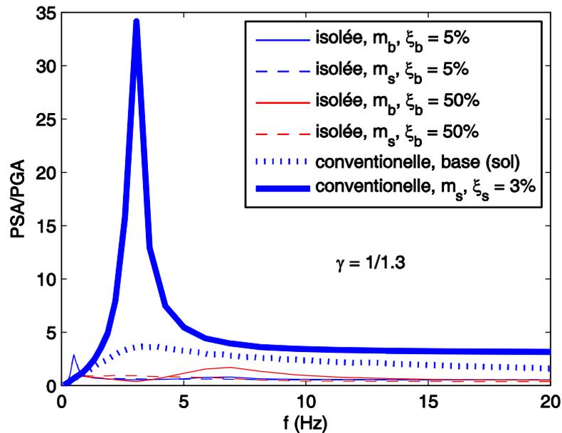
**Figure 4.14. Spectres de plancher pour amortissement de 2% (normalisés par rapport à l'accélération maximum de l'excitation) de la structure sismiquement isolée et de la structure conventionnelle dans le cas d'une excitation bruit blanc filtré**
