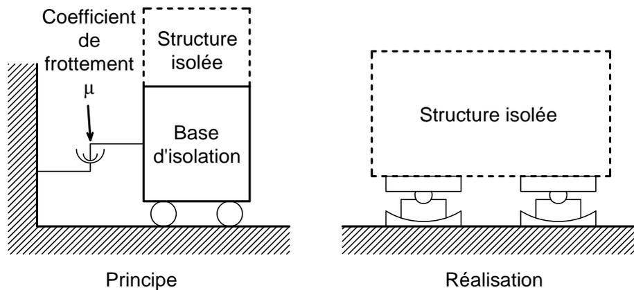
**Figure 2.4. Pendules de frottement (FPS – « Friction Pendulum System »)**
