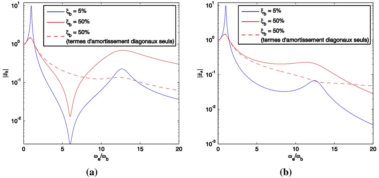
**Figure 4.6. Modules des fonctions de transfert de l'accélération absolue :**
