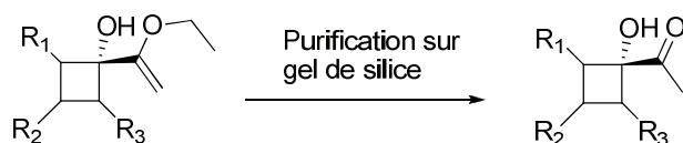
Schéma V-4 – Hydrolyse du produit lors de la purification.
