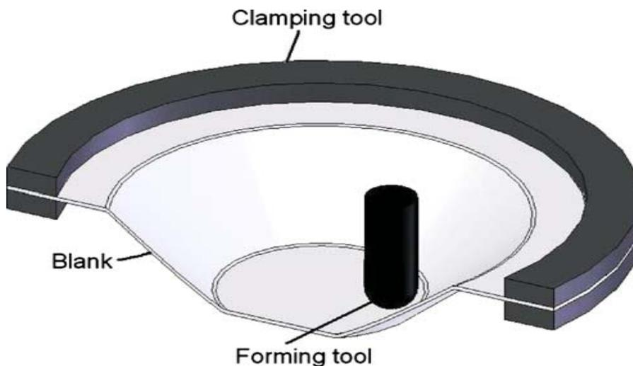
Figure 1-4 : Procédé de formage incrémental [Hadoush et al.08]
