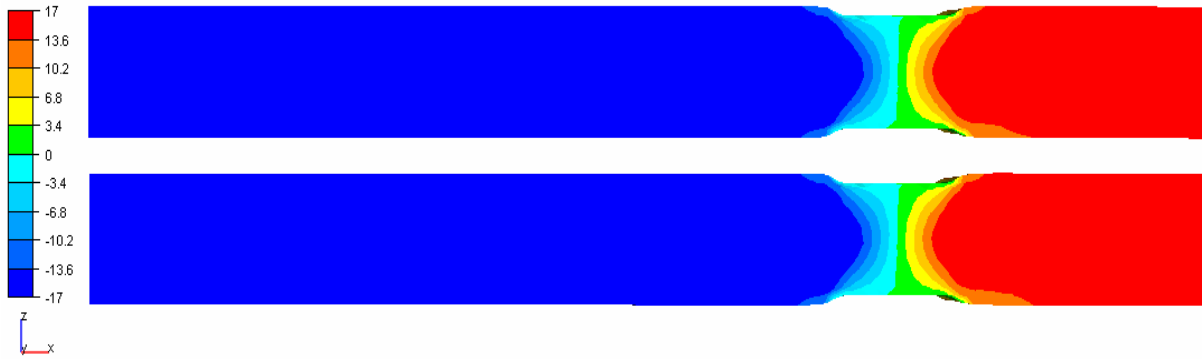
Figure 4-5 : Vitesse : v_x , vue de face: calcul MonoMaillage (haut), calcul MultiMaillages (bas), au dernier incrément
