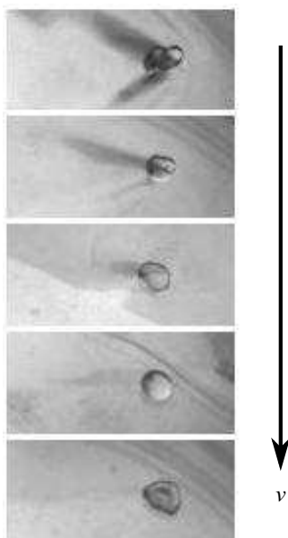
FIGURE 3.14 – Images de gouttes d’azote liquide se déplaçant sur des huiles silicone de viscosité \nu croissante : de haut en bas, \nu = 5, 20, 100, 300 et 1000 cSt. Les gouttes, de rayon R \approx 1,5 mm et de vitesse V \sim 30 cm/s > c_{\min} , sont vues de dessus.
