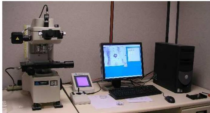
Figure 1 : Microduromètre
