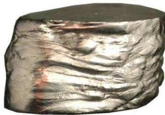
Figure 3.17 : Forme de l'éprouvette de la nuance C après compression
