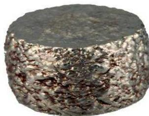
Figure 3.16 : Forme de l'éprouvette après compression de l'acier GX120Mn13
