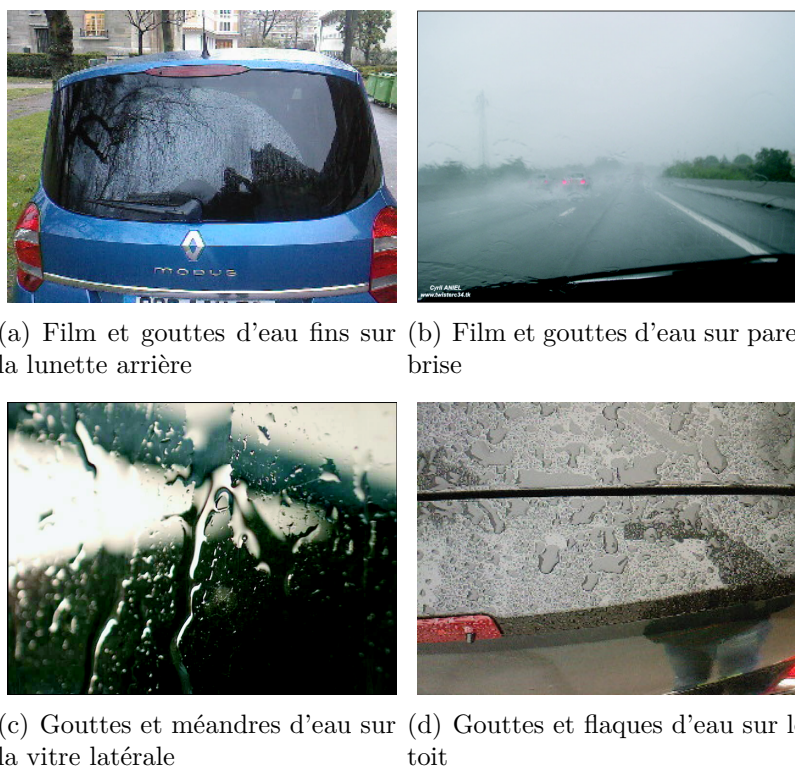
Figure IV.2 – Mouillage et mouillabilité en aérodynamique automobile
