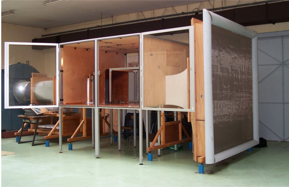
Figure A.1 – La soufflerie Flûte de pan de l'IAT.
