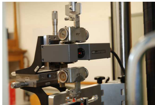
Figure 10 : Mors de traction avec la tête de micromètre laser Mitutoyo LSM-500S montée directement sur un montant de la machine de traction. Le faisceau laser est ajusté perpendiculairement à la fibre (qui est en position verticale) au moyen d'un système de vis micrométrique permettant de contrôler la position de la tête du micromètre laser dans les 3 dimensions.
