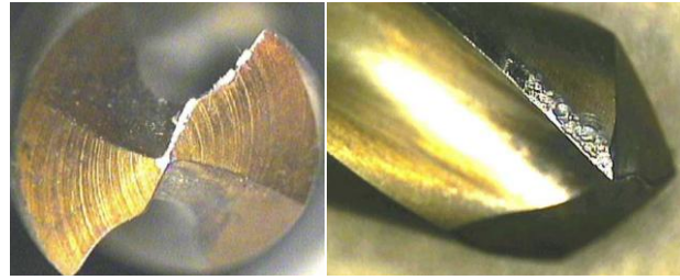
Figure 30 – Adhésion de titane, (a) sur l'arête, (b) sur les listels, après 8 trous \varnothing 6 mm à V_c = 50 m/min et f = 0.07 mm/tr [Cant_05]
