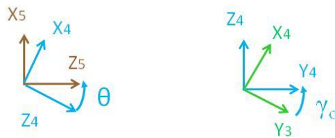
Figure 132 – Schéma de changement de repère entre \{R_4\} et \{R_6\}
