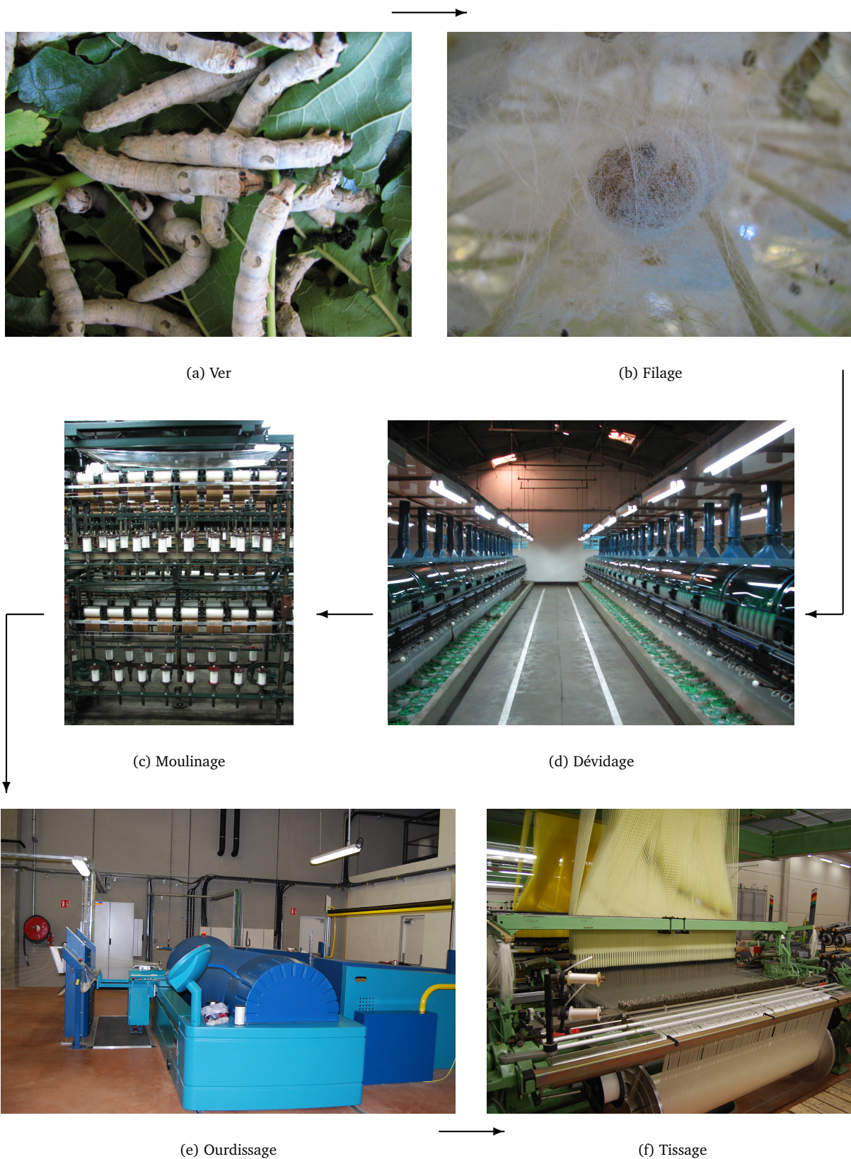
FIG. 1.4 – Procédés industriels : le ver est alimenté en feuille jusqu'à son dernier stade (a), il produit alors son cocon (b) qui est dévidé, associé à d'autres cocons, pour former la flotte (d). Cette flotte est mouillée, les fils sont réunis et tordus pour réaliser des fils de chaîne et de trame enroulés sur des cônes lors des opérations de moulinage (c) puis les fils de chaîne sont disposés en nappe de fils parallèles et tendus lors de l'ourdissage (e) pour être tissés par croisement avec les fils de trame, ici sur un métier Jacquard (f)
