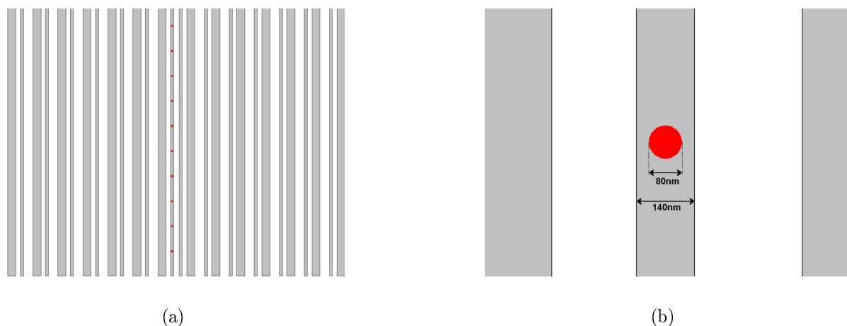
FIGURE 4.20 – Visualisations graphiques du fichier de programmation du nanomasqueur électronique 80keV (premier niveau d'insolation en gris, deuxième niveau en rouge).
