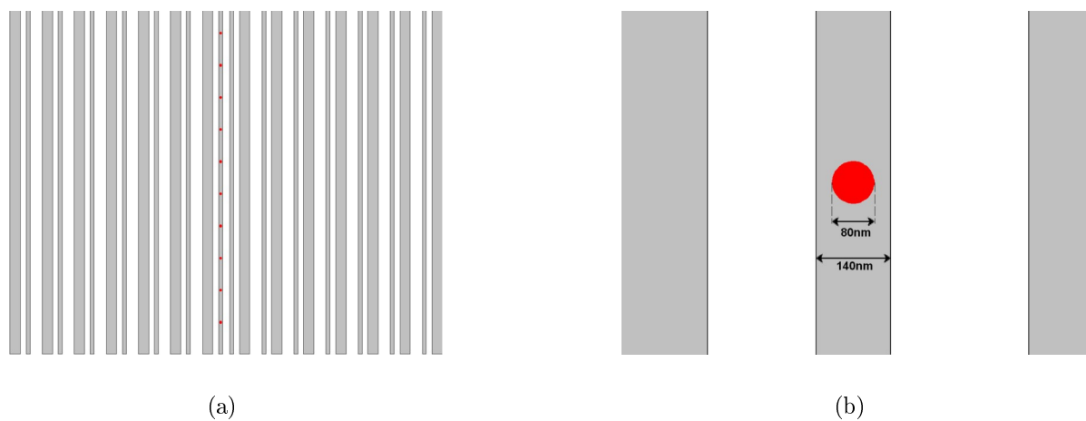
FIGURE 4.20 – Visualisations graphiques du fichier de programmation du nanomasqueur électronique 80\text{keV} (premier niveau d'insolation en gris, deuxième niveau en rouge).
