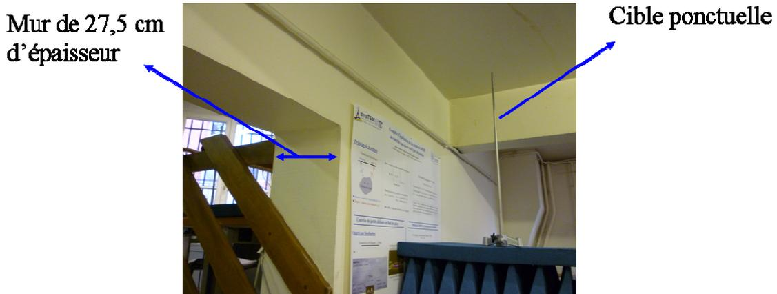
**Figure III.22: Photographie du mur et d'un cylindre métallique placée derrière.**
