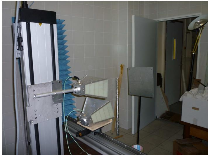
**Figure IV.7: Photographie de la configuration expérimentale. L'antenne supérieure est automatisée en translation grâce à un moteur trois axes.**
