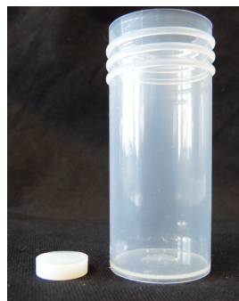
Figure A.2 – Photos représentant un monolithe de silice contenant encore les billes de polymère, après que tout le solvant ait été expulsé et se soit évaporé. À côté, se trouve le flacon ayant servi de moule pour la formation du monolithe.
