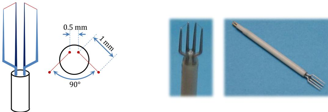
Figure (2.11) : Sonde à fils chauds double utilisée.
