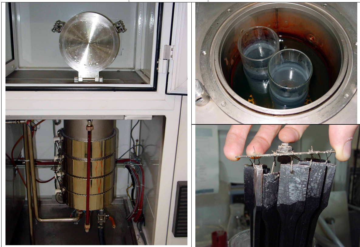
Figure 34 : Photos de l'extérieur de l'autoclave (à gauche), des tubes en immersion dans l'autoclave en vue du dessus (en haut à droite) et du positionnement des éprouvettes dans les tubes (en bas à droite)
