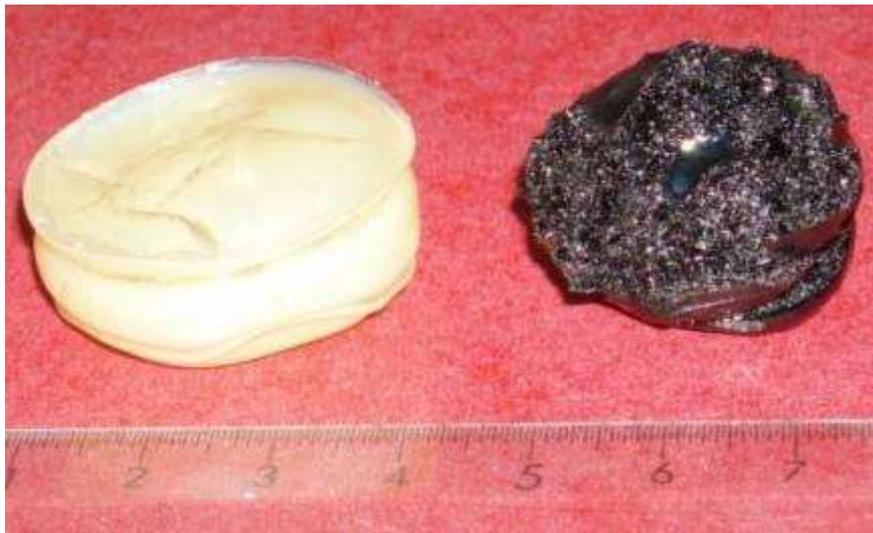
*Figure RLF-10: Aérogel à base d'acétate de cellulose et aérogel carbonisé correspondant*
