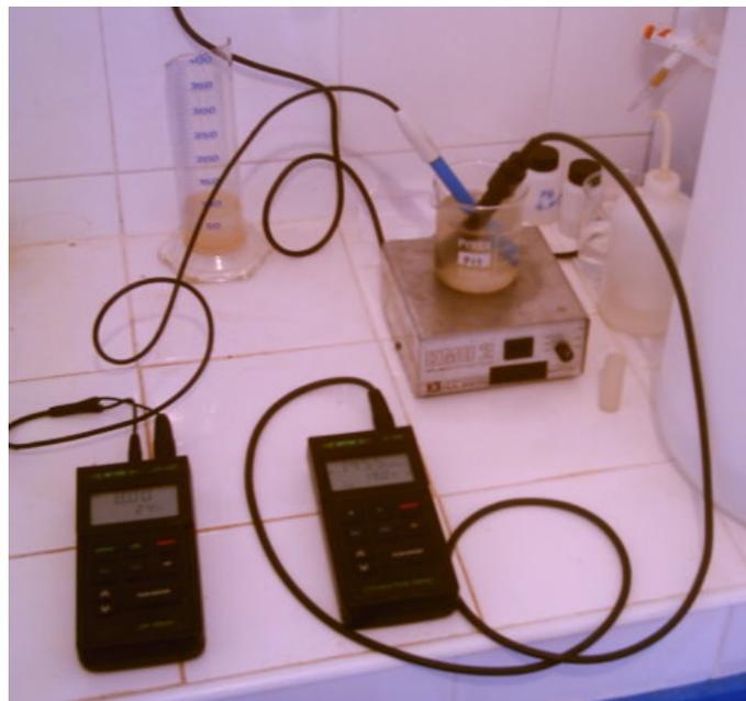
Figure III.5 : Mesures de la conductivité électrique EC (Conductimètre) et du pH (pHmètre).
