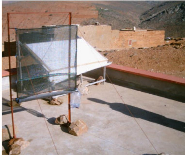
Figure IV.2 : Filet à brouillard de 1 m<sup>2</sup> et condenseur orienté W installés sur le toit d'une école à Idouasskssou grâce au concours d'OPUR et des élèves-ingénieurs de l'Ecole des Mines de Douai. (Coordonnées : 29° 34' 03" N, 9° 59' 51" W, altitude 240 m à l'est de Mirleft).
