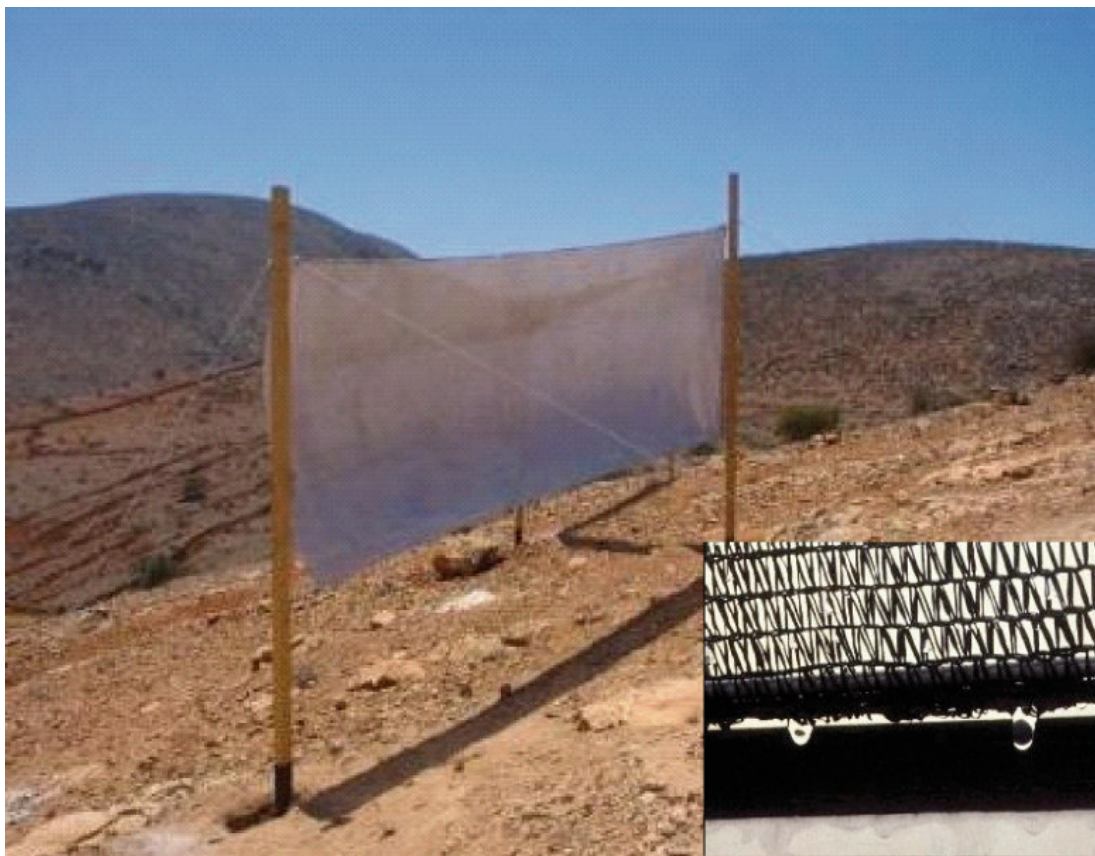
Figure II.13 : Filet en polypropylène pour collecter l'eau du brouillard (Mirleft). Les gouttelettes du brouillard sont piégées dans les mailles du filet.
