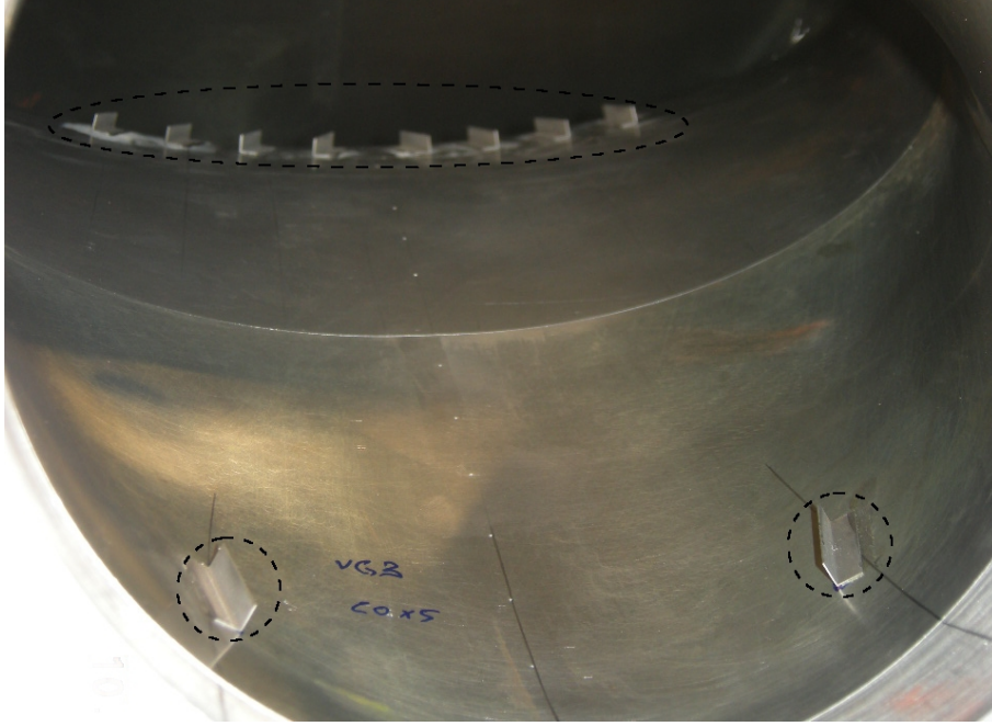
FIGURE 1.3 – Générateurs de vortex à l'intérieur d'une manche à air pour essais en soufflerie. Deux VG sont visibles au premier plan ainsi qu'une série de huit dans le fond de la manche.
