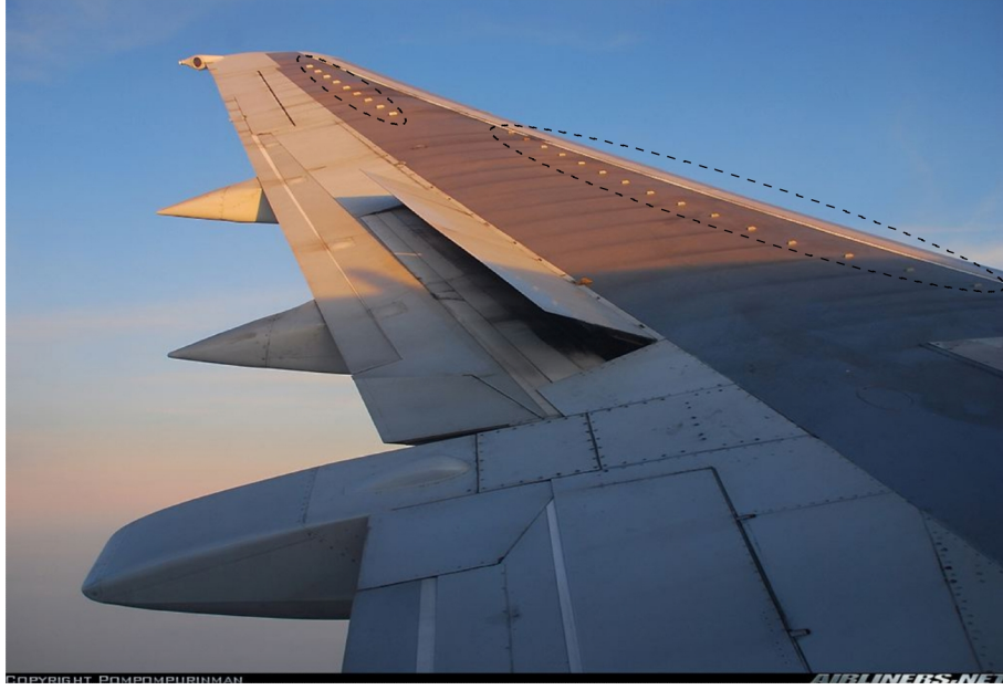
FIGURE 1.4 – Générateurs de vortex sur l’aile d’un Boeing 737. Les deux séries de 15 et 9 VG sont cerclées.
