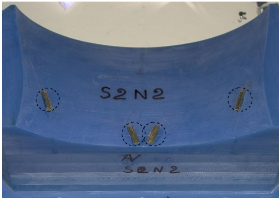
FIGURE 1.2 – Générateurs de vortex sur le capot d'une manche à air pour essais en soufflerie. Les quatre VG sont cerclés.
