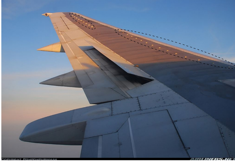
FIGURE 1.4 – Générateurs de vortex sur l’aile d’un Boeing 737. Les deux séries de 15 et 9 VG sont cerclées.
