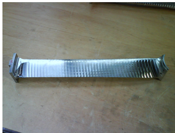
Figure 3.4.3.A : Une des 5 pales en cours d'usinage – source IRENav
