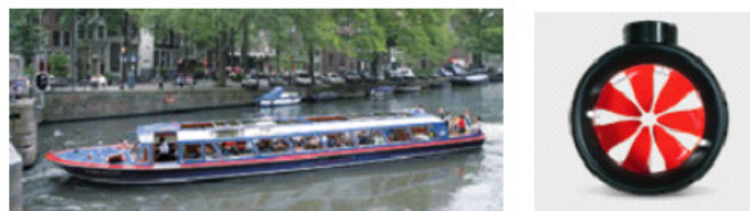
Figure 1.1.2.Y : Exemple d'un bateau, le Barleaus - Blue Boat Company, équipé de propulseurs RD développés par Voith Hydro.
