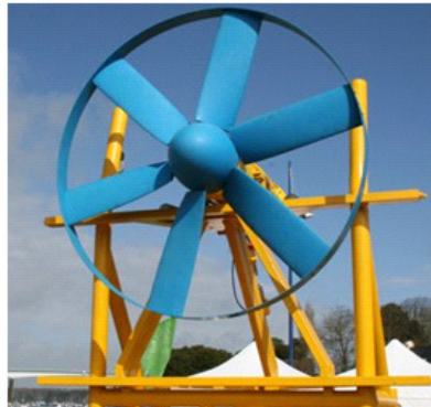
Figure 3.3.2.A : Hélice d'hydrolienne cerclée présentant un profil symétrique et une corde quasi-constante (photo Sabella)
