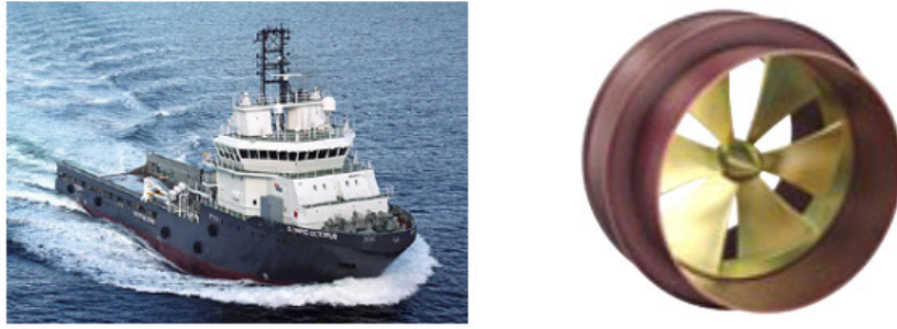
Figure 1.1.2.W : Le navire olympic octopus équipé d'un propulseur d'étrave Rim Driven conçu par Rolls-Royce (2006)
