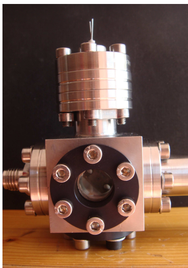
FIGURE 2.8 – Photographie du réacteur au sein duquel est placé le sandwich électrode-diélectrique-électrode.
