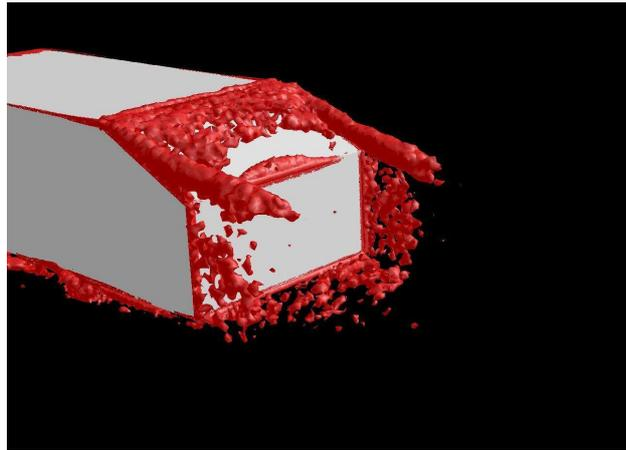
FIG. 2.14 – Visualisation d'iso-surfaces  $Q = 13000$  sur corps d'Ahmed (angle de lunette  $\phi = 26^\circ$ ).  $U_0 = 20 m.s^{-1}$ .
