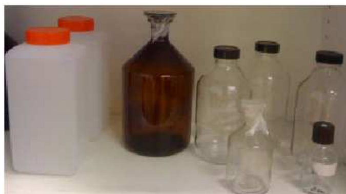
Figure 42. Flaconnages nécessaires pour le transfert des échantillons vers le laboratoire accrédité
