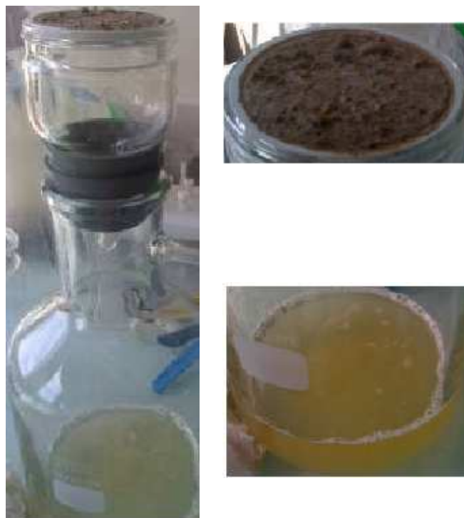
Figure 41. Phases obtenues après filtration d'un échantillon d'eau pluviale
