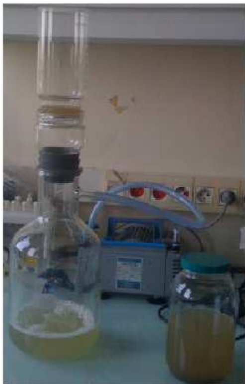
Figure 40. Montage utilisé pour la filtration des échantillons aqueux
