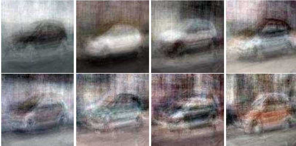
FIGURE 3.8 – Voitures propres ou eigencars : quelques composantes principales obtenues dans la décomposition d'images de voitures (dont les 4 premières).
