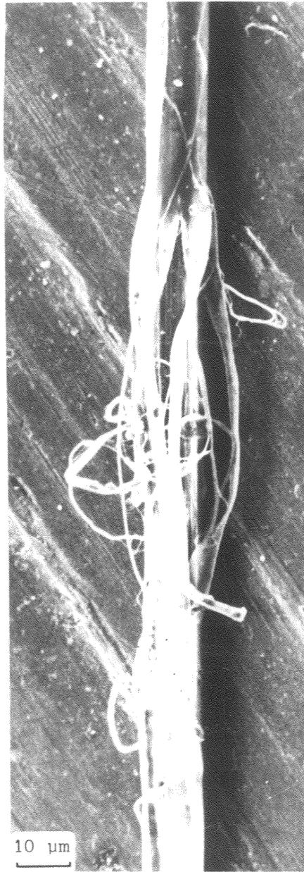
Figure II.3 : Endommagement d'une fibre avant essai.
