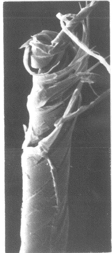
Figure VI.10 : Morphologie de rupture de deux fibres soumises à une torsion autour de leur génératrice commune.
