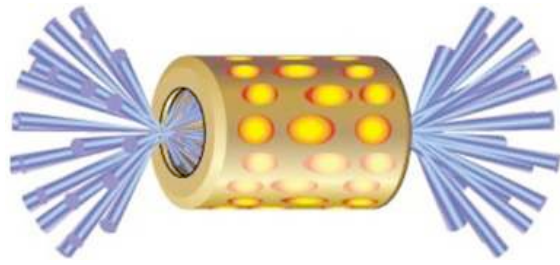
Confinement inertiel indirect. Les rayons X créés dans la cavité compriment la caspule qu'elle contient.
