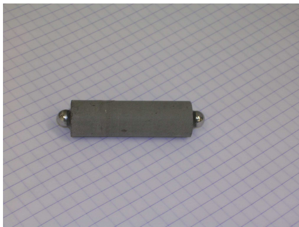
FIG. 3.10 – Echantillon cylindrique instrumenté avec des billes.
