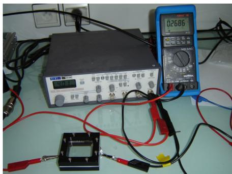
**Figure 5.2** – Photo du dispositif expérimental permettant la fabrication de vésicules par électroformation.
