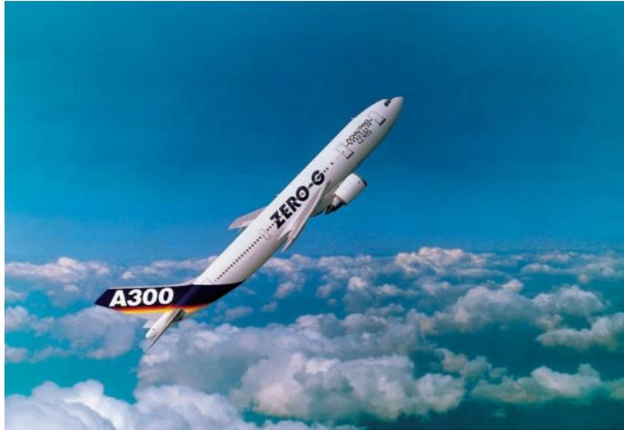
**Figure 2.21** – *A300-0g en phase d'hyperpesanteur, juste avant la période de micropesanteur.*
