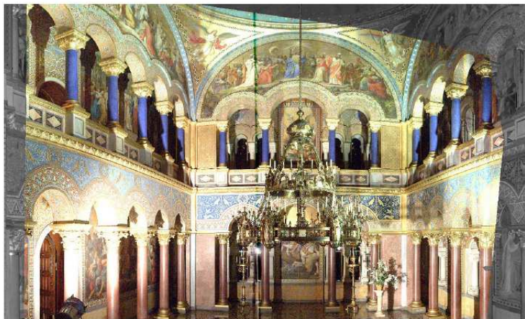
Figure 48 Le hall du château Neuschwanstein : l'image de luminance du scanner est mélangée avec les valeurs RVB correspondantes acquises par la caméra. [Abmayr T. et al., 2004].
