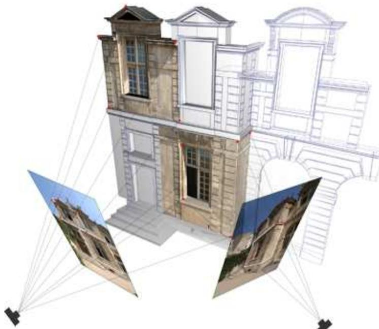
**Figure 47** Calibration et orientation des caméras
