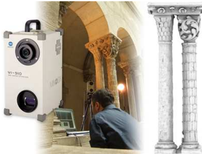
Figure 36 Un scanner laser 3D à triangulation optique et le résultat obtenu (maillage polygonal d'un élément sculpté).
