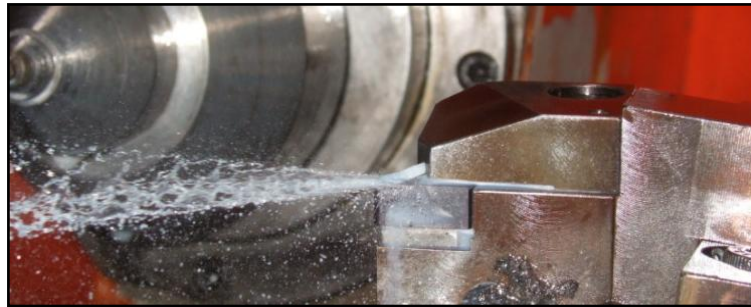
Figure IV-21: Vue d'un outil avec assistance jet d'eau haute pression
