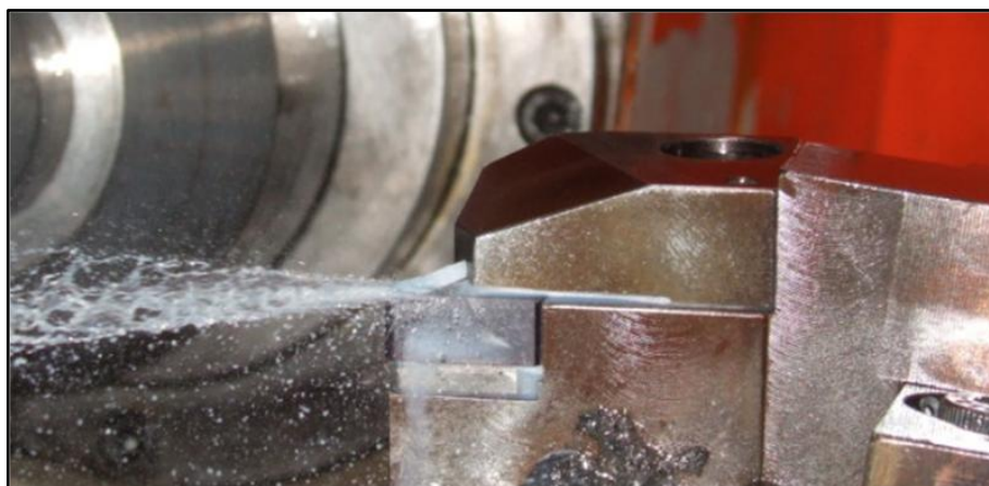
Figure I-19: configuration de l'usinage assisté jet d'eau haute pression
