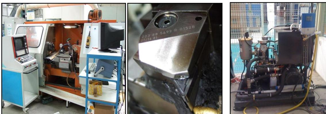
Figure IV-22: Dispositif de l'assistance jet d'eau haute pression
