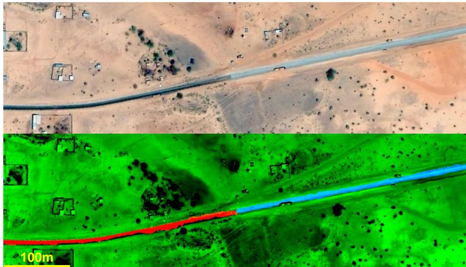
Figure 143 : Détection du revêtement d'une route à la sortie est de Massaguet
