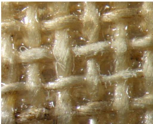
Figure 179 : élimination du Plextol® B500,  $\lambda$  : 248 nm,  $F = 1,78 \text{ J/cm}^2$ . 40 pulses, Ablation <sup>+++</sup>
