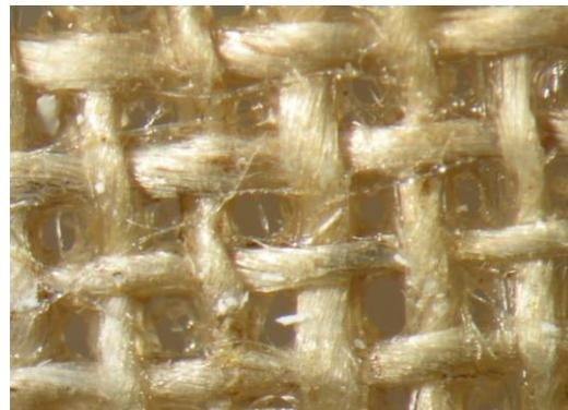
Figure 177 : élimination du Plectol® B500,  $\lambda$  : 193 nm, F = 2,5 J/cm<sup>2</sup>.40 pulses, aucun effet
