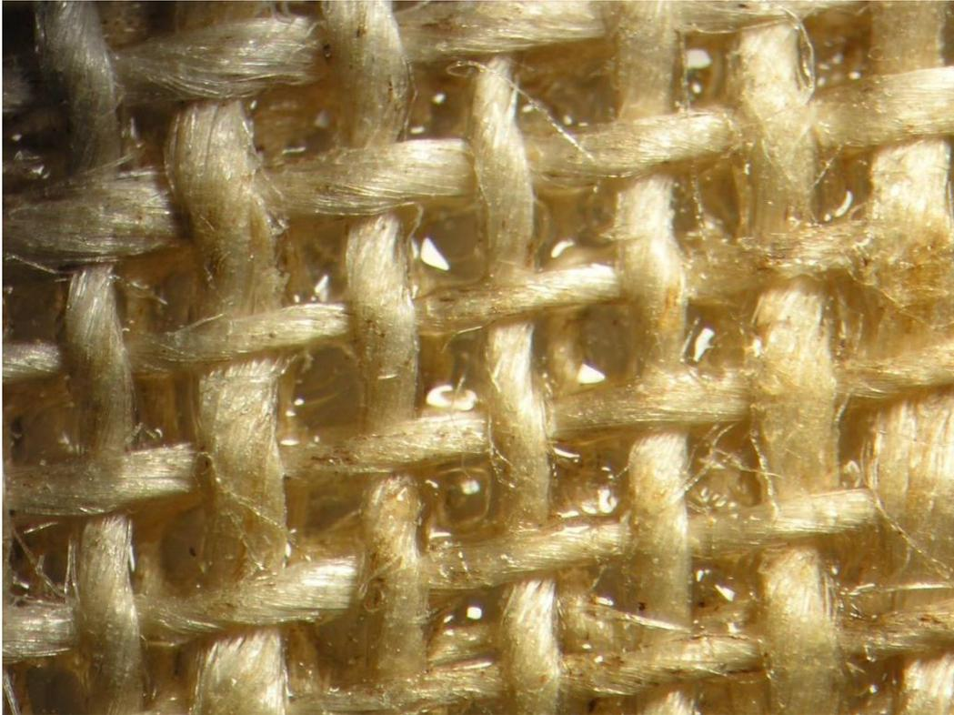
Figure 146 : élimination de la Mowilith® DMC2,  $\lambda$  : 248 nm,  $F = 1,12 \text{ J/cm}^2$ .40 pulses, Ablation <sup>+++</sup>
