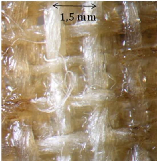
Figure 162 : élimination de la Mowilith® DM5,  $\lambda$  : 532 nm,  $F = 1,87 \text{ J/cm}^2 \cdot 5 \text{ pulses}$ , décoloration des fibres
