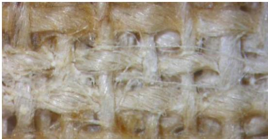
Figure 121 : élimination de la colle de pâte,  $\lambda$  : 532 nm,  $F = 1,87 \text{ J/cm}^2$ , 5 pulses, Ablation <sup>+++</sup>
