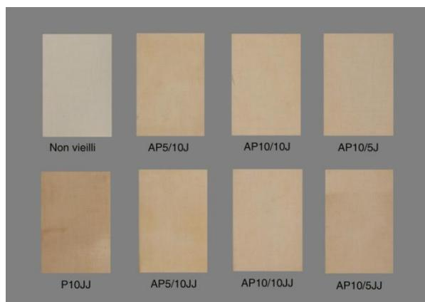
Figure 32 : échantillons vieillis de toiles marouflées
