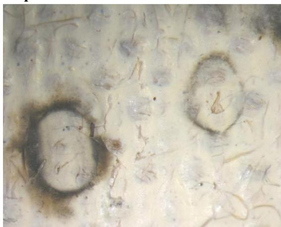
Figure 125 : élimination de la cêruse,  $\lambda$  : 193 nm, 2,5 J/cm<sup>2</sup>, 40 pulses, aucun effet
