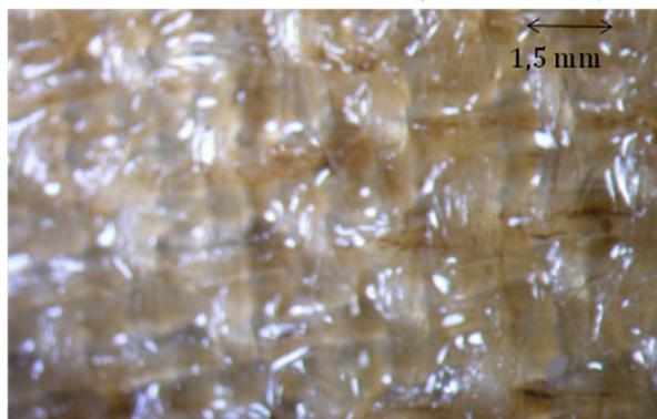
Figure 154 : élimination de la Mowilith® DM5,  $\lambda$  : 193 nm, F = 1,7 J/cm<sup>2</sup>.40 pulses, aucun effet
