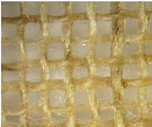
Figure 135 : élimination de la Beva®,  $\lambda$  : 248 nm, F = 1,12 J/cm<sup>2</sup>.10 pulses, Ablation <sup>+++</sup>
