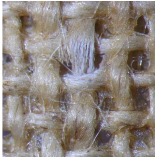
Figure 114 : élimination de la colle de pâte,  $\lambda$  : 248 nm, F = 2,6 J/cm<sup>2</sup>. 10 and 40 pulses, Ablation <sup>+</sup>
