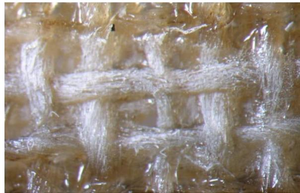
Figure 159 : élimination de la Mowilith® DM5,  $\lambda$  : 248 nm,  $F = 2,5 \text{ J/cm}^2$ .40 pulses, Ablation <sup>+++</sup>
