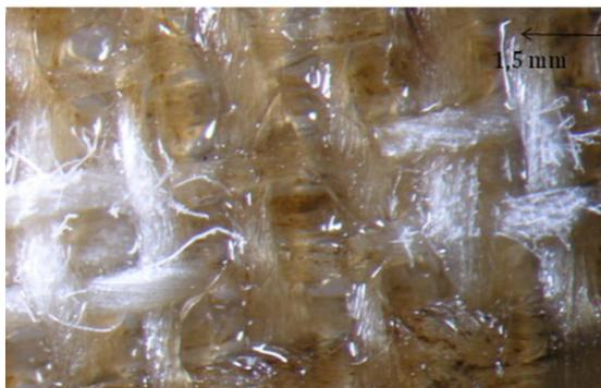
Figure 160 : élimination de la Mowilith® DM5,  $\lambda$  : 355 nm,  $F = 2 \text{ J/cm}^2$ .40 et 10 pulses, Ablation <sup>++</sup>
