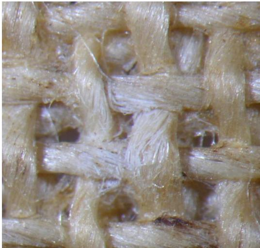
Figure 113 : élimination de la colle de pâte,  $\lambda$  : 248 nm, F = 1,12 J/cm<sup>2</sup>. 10 and 40 pulses, Ablation <sup>+</sup>
