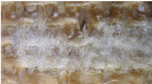
Figure 122 : élimination de la colle de pâte,  $\lambda$  : 532 nm,  $F = 3,15 \text{ J/cm}^2$ , 5pulses, Ablation <sup>+</sup>, fibres rompues
