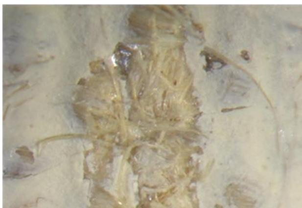
Figure 130 : élimination de la cêruse,  $\lambda$  : 532 nm, F = 1,87 J/cm².5 pulses, Ablation <sup>+++</sup>
