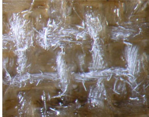
Figure 157 : élimination de la Mowilith® DM5,  $\lambda$  : 248 nm,  $F = 1,78 \text{ J/cm}^2$ .10 pulses, Ablation <sup>+++</sup>
