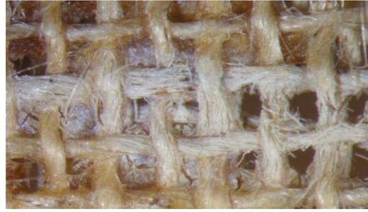
Figure 118 : élimination de la colle de pâte,  $\lambda$  : 248 nm,  $F = 2,49 \text{ J/cm}^2$ .40 pulses, Ablation <sup>+</sup>, fibres rompues
