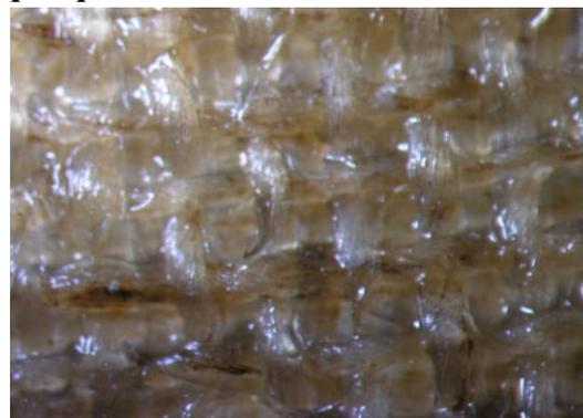
Figure 155 : élimination de la Mowilith® DM5,  $\lambda$  : 193 nm, F = 2,5 J/cm<sup>2</sup>.40 pulses, aucun effet
