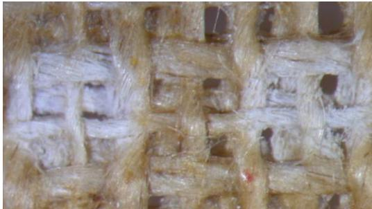
Figure 119 : élimination de la colle de pâte,  $\lambda$  : 355 nm,  $F = 2 \text{ J/cm}^2$ .40 et 10 pulses, Ablation <sup>++</sup>
