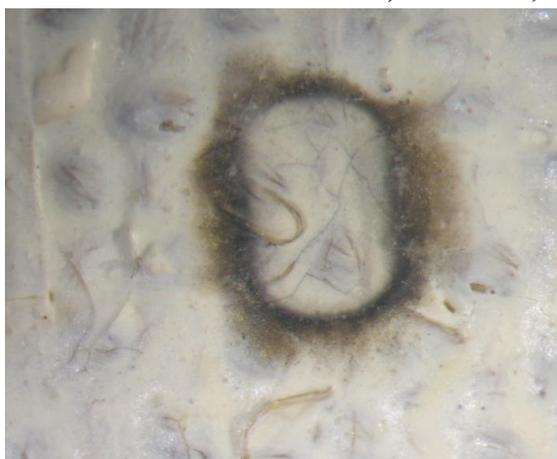
Figure 124 : élimination de la cêruse,  $\lambda$  : 193 nm, 1,7 J/cm<sup>2</sup>, 40 pulses, aucun effet
