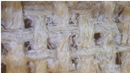
Figure 115 : élimination de la colle de pâte,  $\lambda$  : 248 nm, F = 1,78 J/cm<sup>2</sup>. 10 pulses, Ablation <sup>+++</sup>
