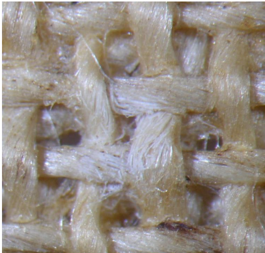
Figure 113 : élimination de la colle de pâte, \lambda : 248 nm, F = 1,12 J/cm 2 . 10 and 40 pulses, Ablation +
