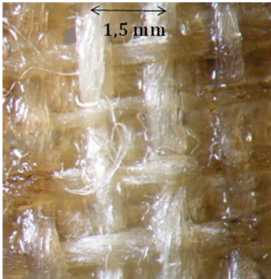
Figure 162 : élimination de la Mowilith® DM5, \lambda : 532 nm, F = 1,87 \text{ J/cm}^2 \cdot 5 \text{ pulses} , décoloration des fibres
