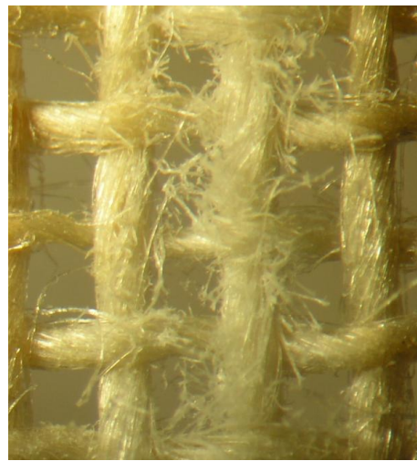
Figure 174 : élimination du Plexisol® P550, \lambda : 532 nm, F = 3,15 \text{ J/cm}^2 .5pulses, décoloration des fibres
