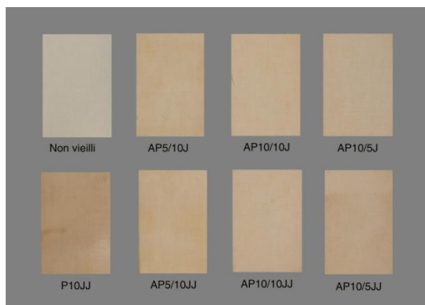
Figure 32 : échantillons vieillis de toiles marouflées
