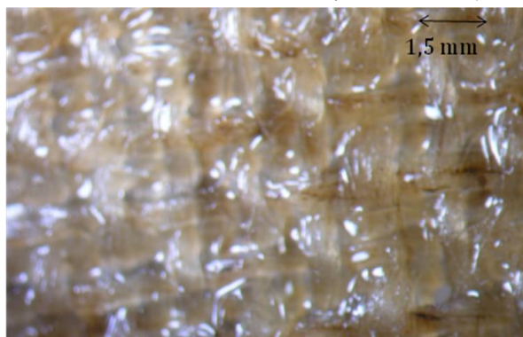
Figure 154 : élimination de la Mowilith® DM5, \lambda : 193 nm, F = 1,7 J/cm 2 .40 pulses, aucun effet
