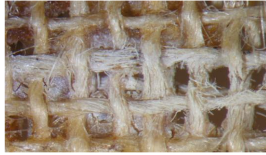
Figure 118 : élimination de la colle de pâte, \lambda : 248 nm, F = 2,49 \text{ J/cm}^2 .40 pulses, Ablation + , fibres rompues
