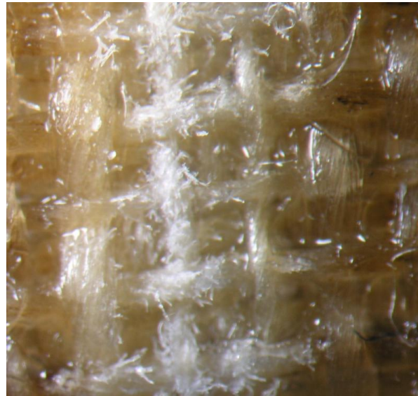
Figure 163 : élimination de la Mowilith® DM5, \lambda : 532 nm, F = 3,15 \text{ J/cm}^2 \cdot 5 \text{ pulses} , décoloration des fibres
