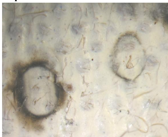
Figure 125 : élimination de la cêruse, \lambda : 193 nm, 2,5 J/cm 2 , 40 pulses, aucun effet
