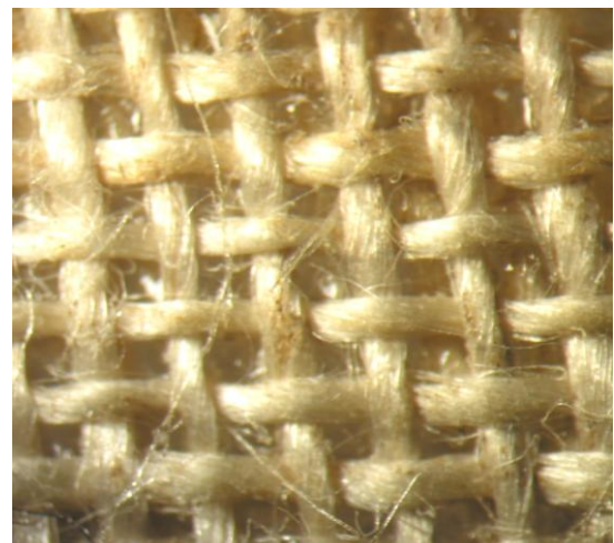
Figure 145 : élimination de la Mowilith® DMC2, \lambda : 193 \text{ nm} , 2,5 \text{ J/cm}^2 .40 pulses, Ablation +++
