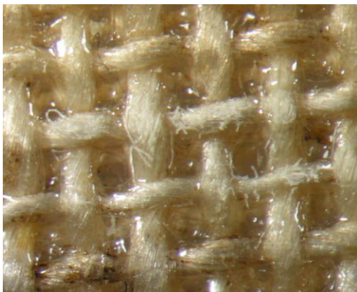
Figure 179 : élimination du Plextol® B500, \lambda : 248 nm, F = 1,78 \text{ J/cm}^2 . 40 pulses, Ablation +++
