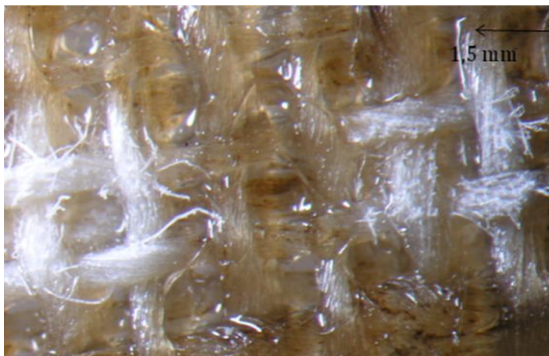
Figure 160 : élimination de la Mowilith® DM5, \lambda : 355 nm, F = 2 \text{ J/cm}^2 .40 et 10 pulses, Ablation ++
