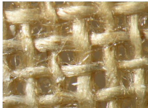
Figure 177 : élimination du Plectol® B500, \lambda : 193 nm, F = 2,5 J/cm 2 .40 pulses, aucun effet
