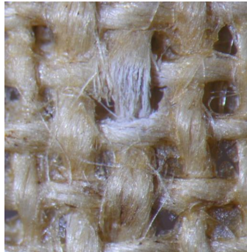
Figure 114 : élimination de la colle de pâte, \lambda : 248 nm, F = 2,6 J/cm 2 . 10 and 40 pulses, Ablation +
